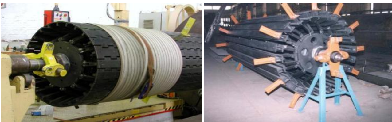
Slika 10. Šablone za izradu trafo namota
