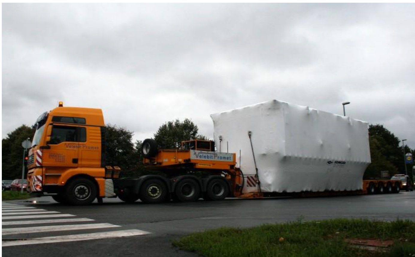
Slika 26. Izvanredni transport transformatorskog kotla velikih gabarita
