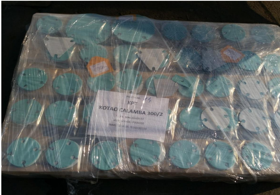
Slika 29. Dijelovi transformatorskog kotla zapakirani po posebnim uputama kupca (KPT - Končar Transformatori)
