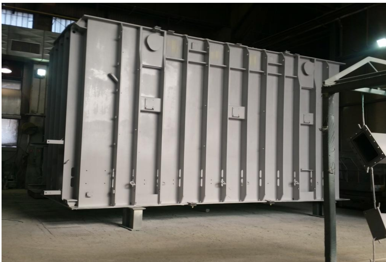
Slika 27. Sušenje transformatorskog kotla nakon nanesenog prvog premaza
