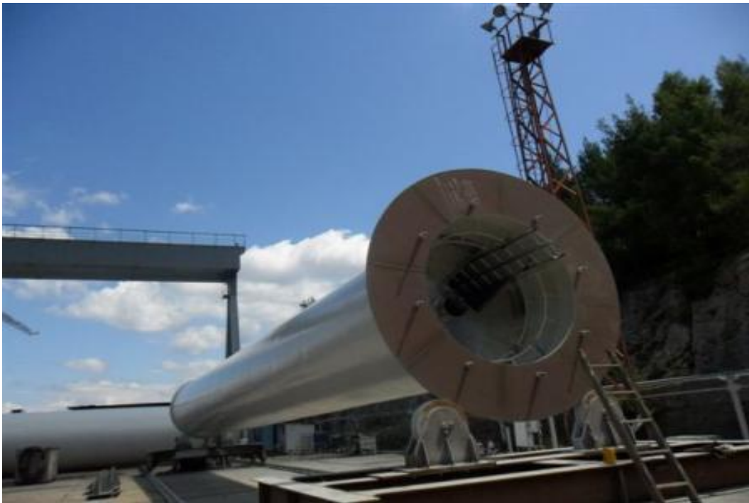
Slika 8. Toranj vjetroelektrane proizveden u KMK
