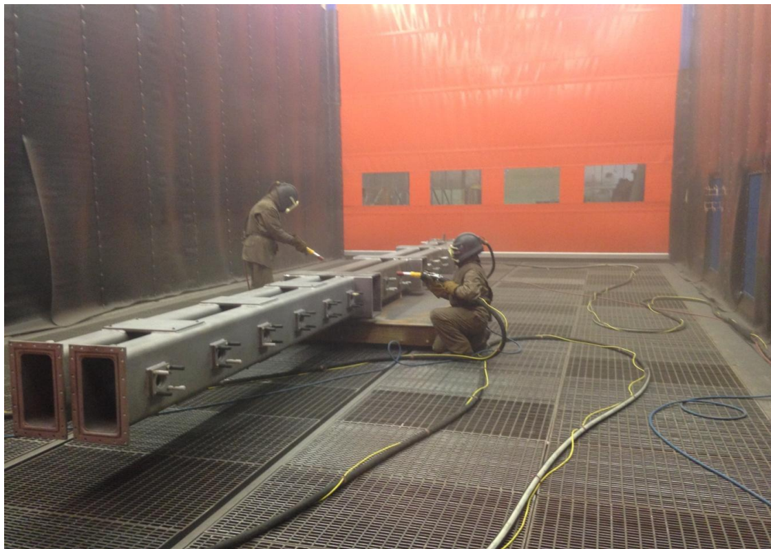
Slika 20. Pjeskarenje proizvoda u komori
