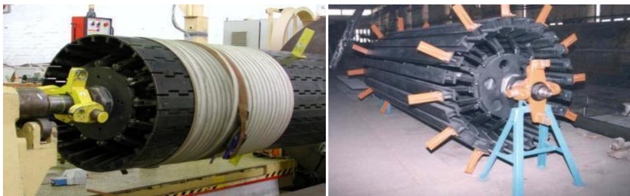
Slika 10. Šablone za izradu trafo namota
