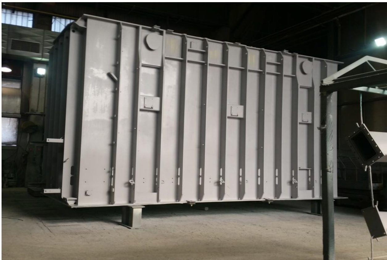
Slika 27. Sušenje transformatorskog kotla nakon nanesenog prvog premaza
