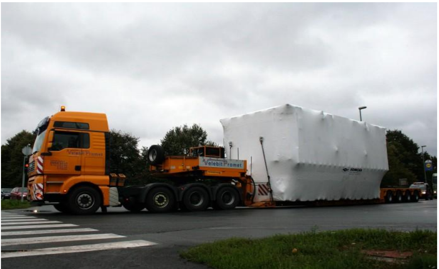
Slika 26. Izvanredni transport transformatorskog kotla velikih gabarita
