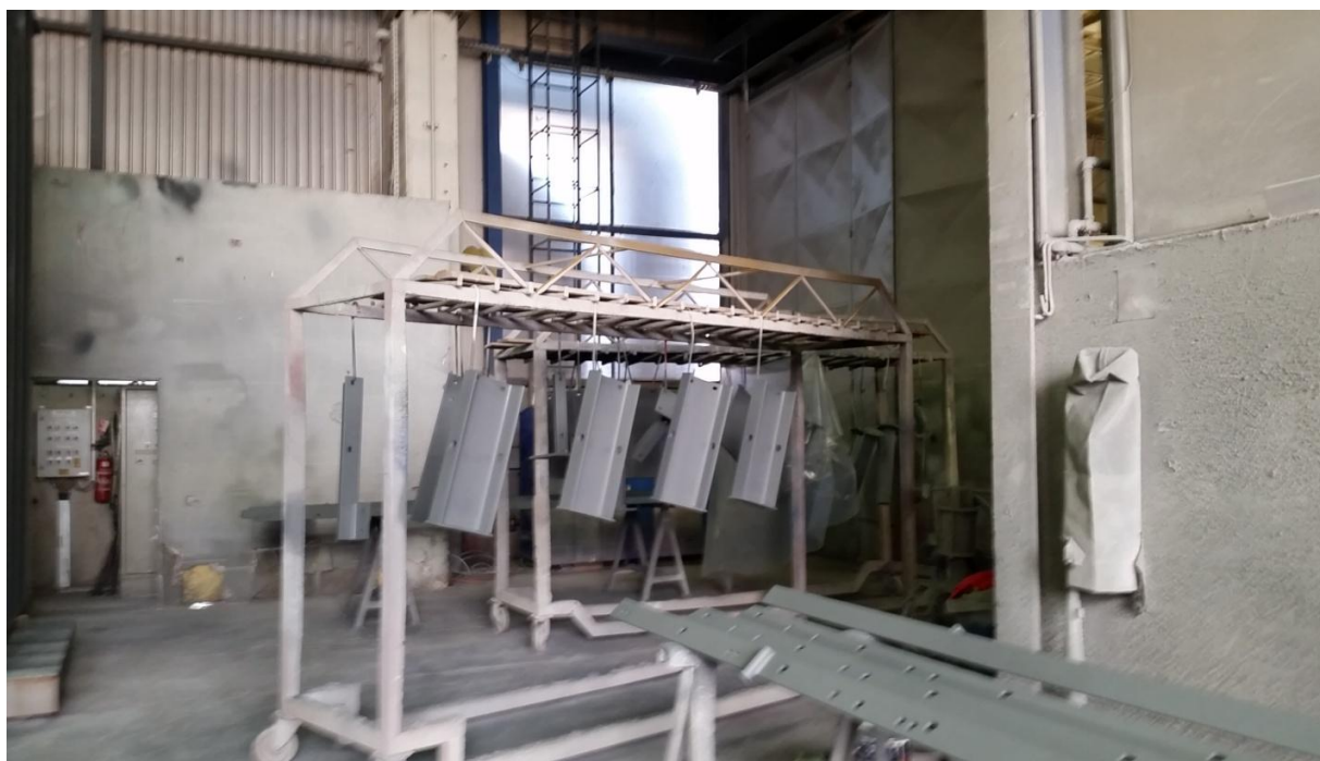
Slika 28. Sušenje manjih dijelova nakon završnog (trećeg) sloja
