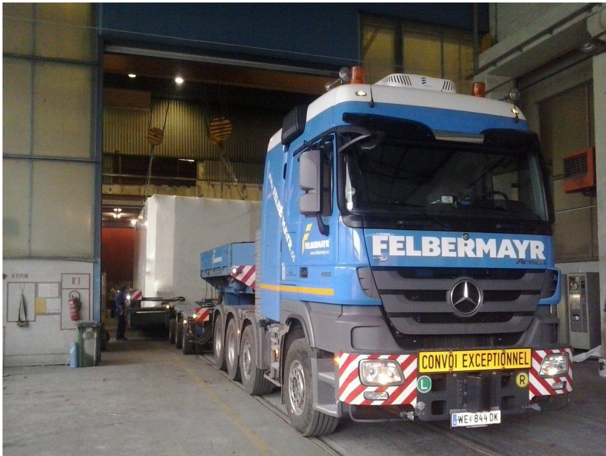
Slika 34. Utovar kotla na transportno vozilo
