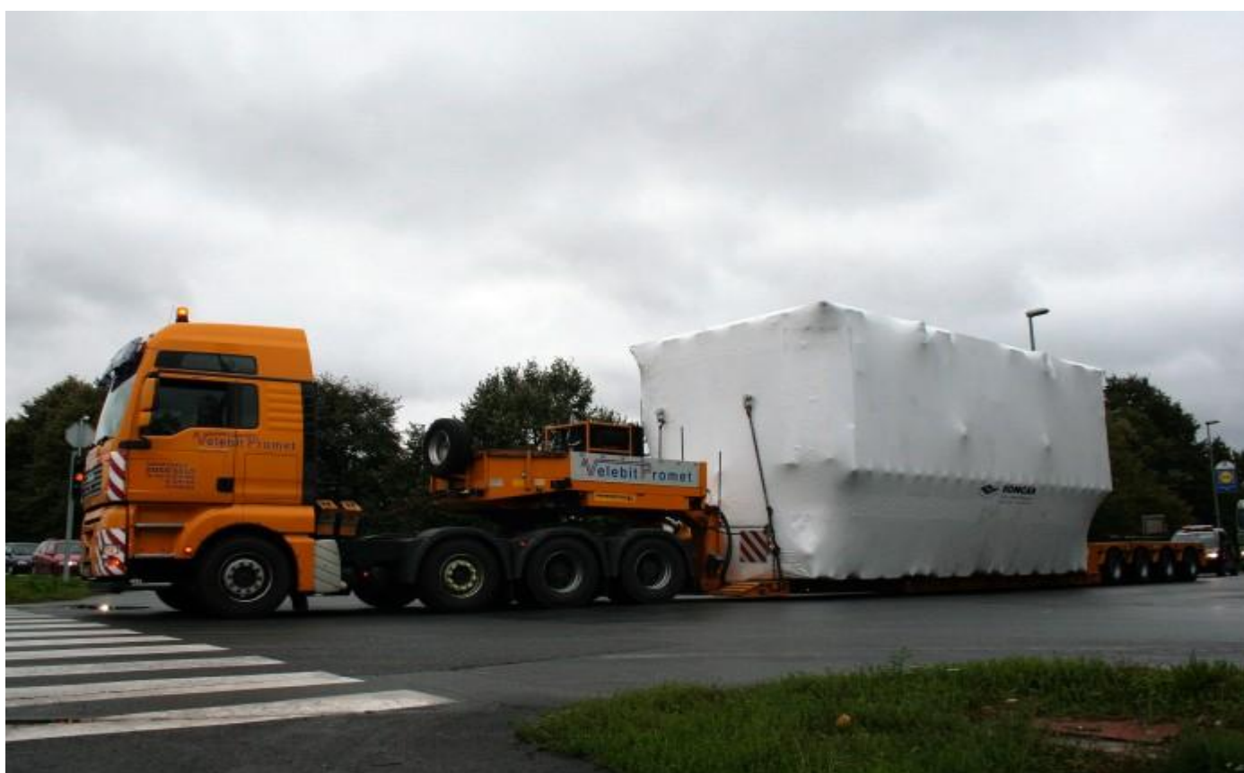
Slika 26. Izvanredni transport transformatorskog kotla velikih gabarita
