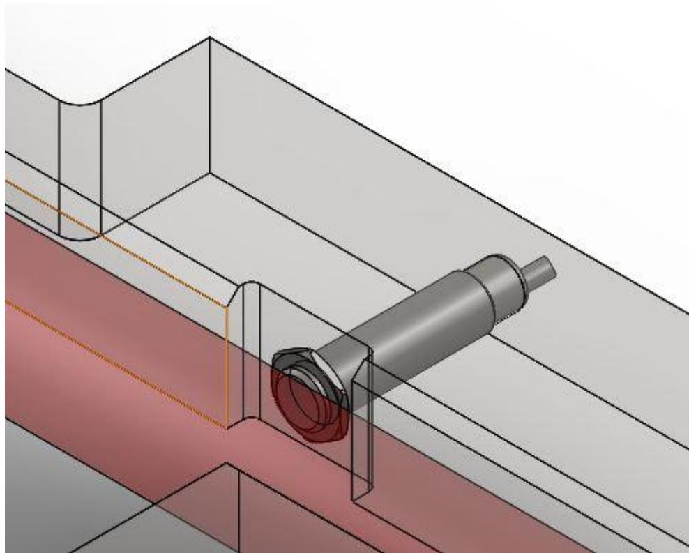
**Slika 34. Infracrveni senzor na ploči za odabir segmenta**
