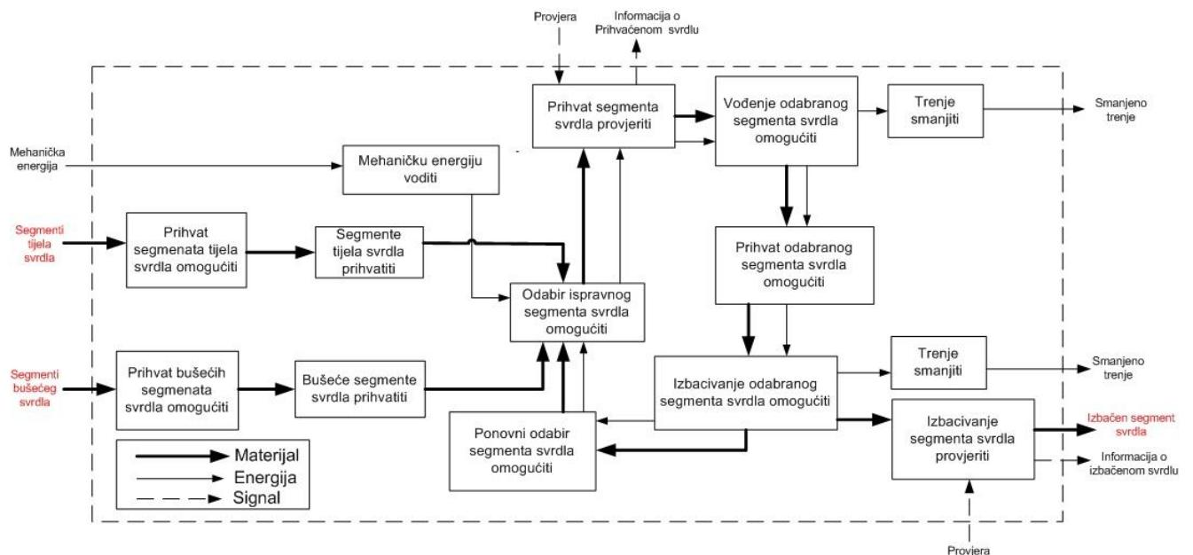
Slika 17. Funkcijska dekompozicija stroja za dobavu segmentiranih svrdla
