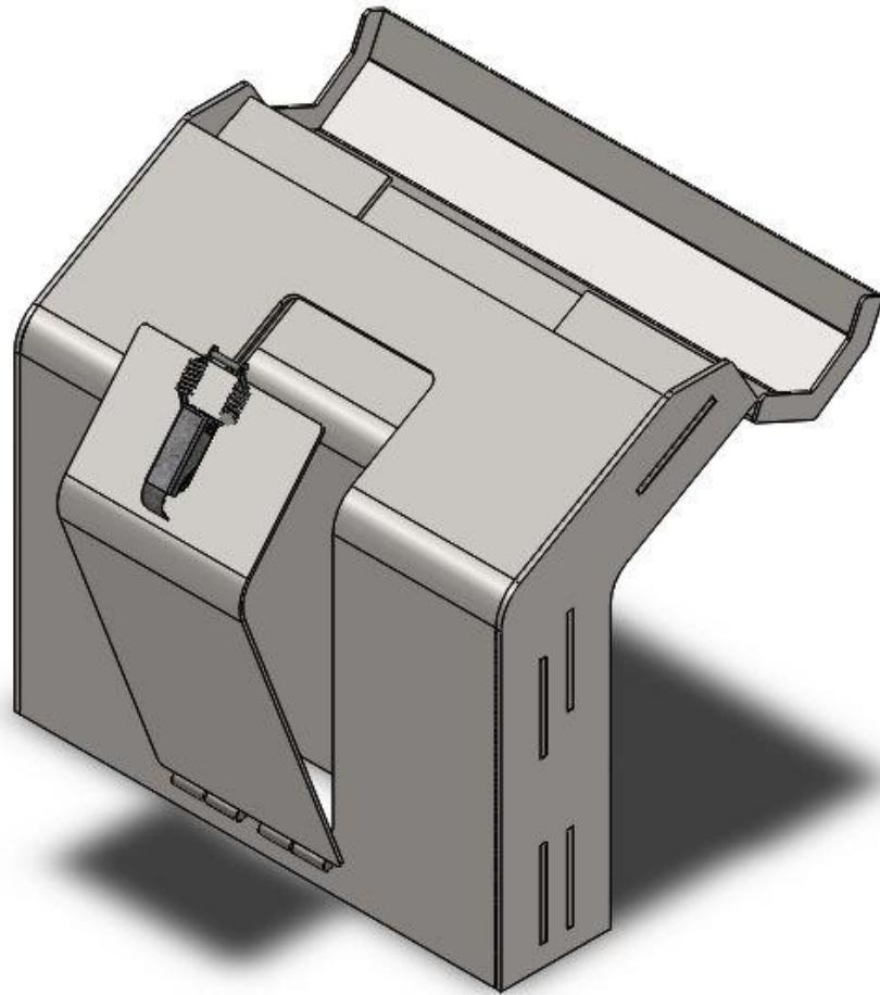
Slika 32. Konačni izgled spremnika za segmente s ugrađenim poklopcima
