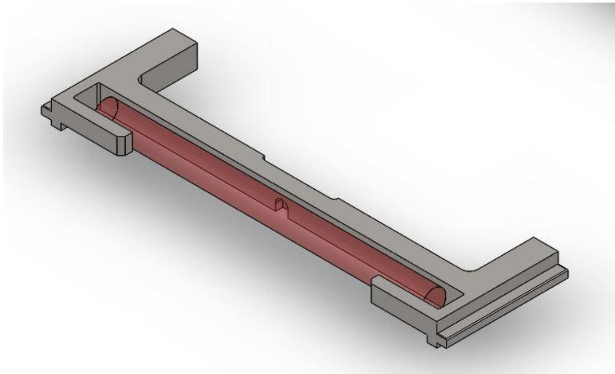
Slika 35. Ploča s rezom za izbacivanje odabranog segmenta
