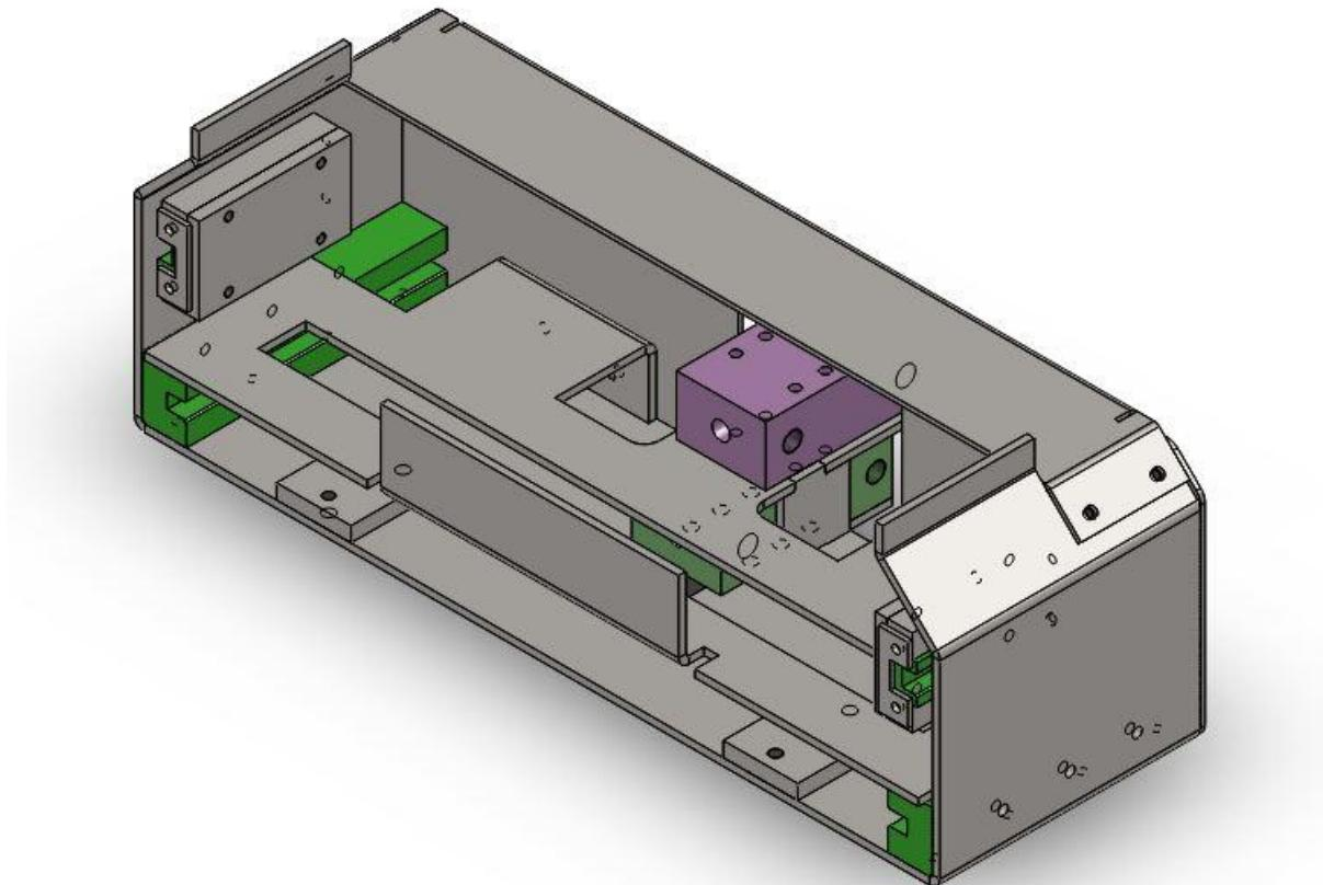
**Slika 36. Nosač spremnika segmenata i hidrauličkih blok cilindara**
