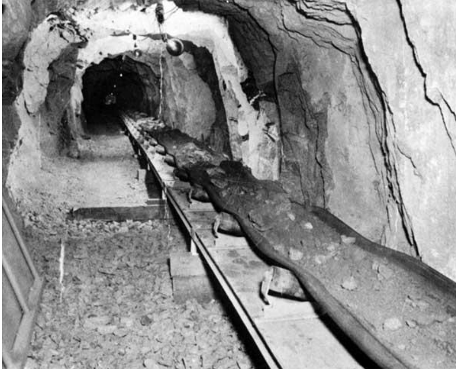
Slika 3. Rudarska pokretna traka za transport rasutog tereta (rude)
