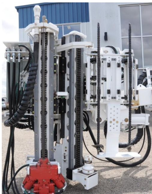
Slika 14. Prikaz sustava za dobavu sidra
