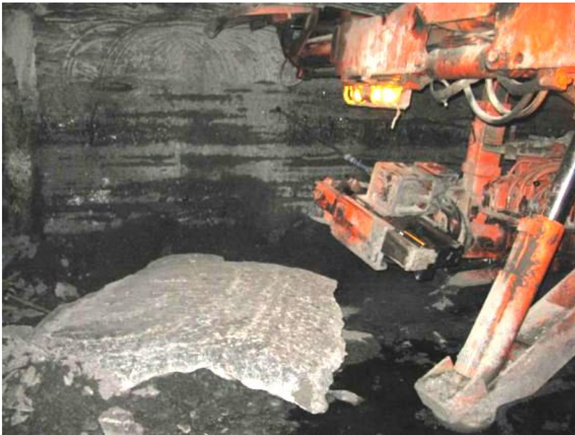
Slika 5. Odlomljeni dio stijene čiji je pad usmrtio rudara (2013., SAD)
