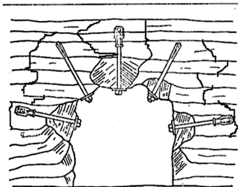
**Slika 8. Presjek okna rudnika s ugrađenim sidrima**
