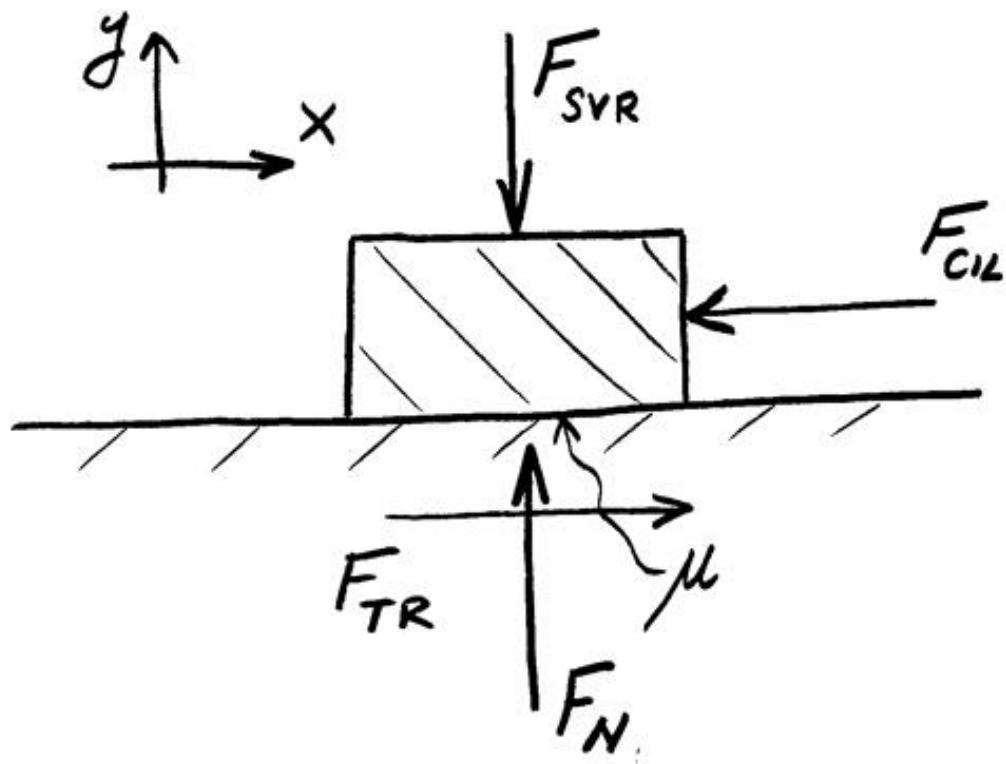
Slika 38. Sile na ploči s izrezom za odabir segmenta
