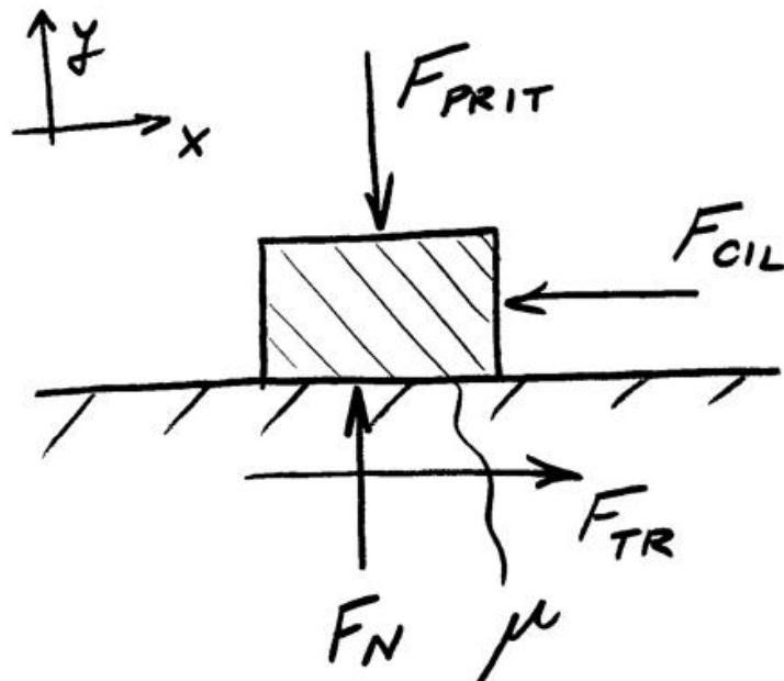
Slika 39. Sile na blok cilindru i podlozi
