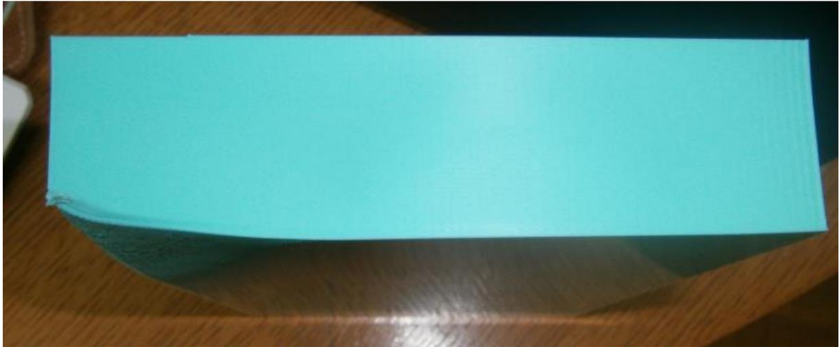
Slika 7.9 Izradak isprintan pri temperaturi radne podloge od 115°C
