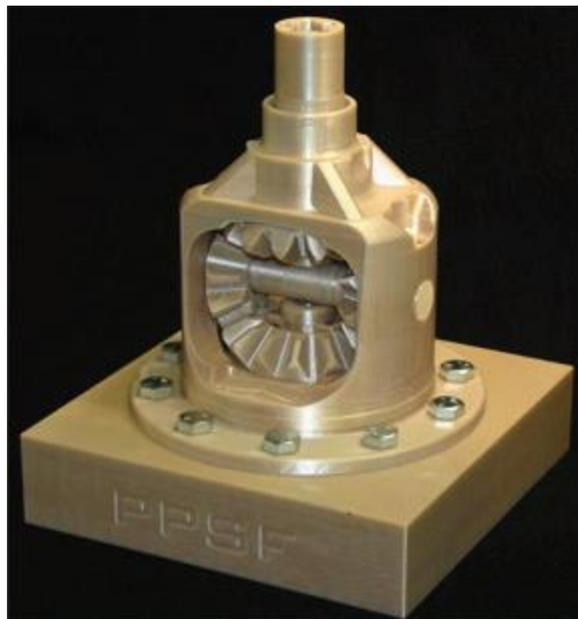
Slika 6.2 PPSF kućište zupčanika [1]
