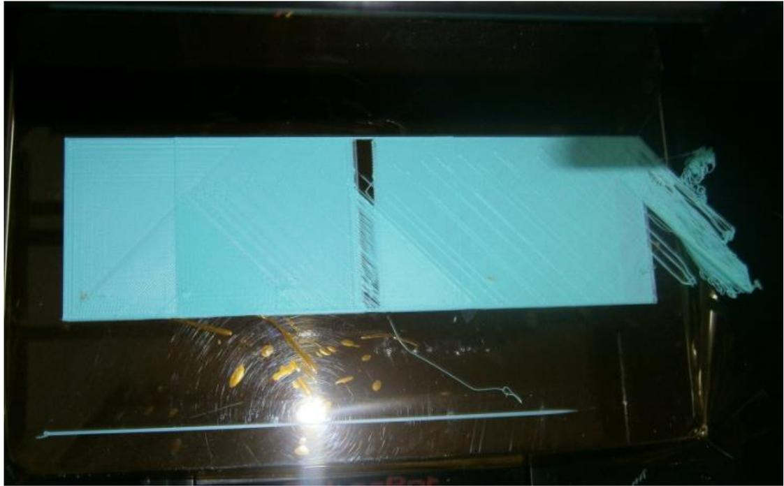
Slika 7.13 Razvlačenje niti materijala na desnom modelu
