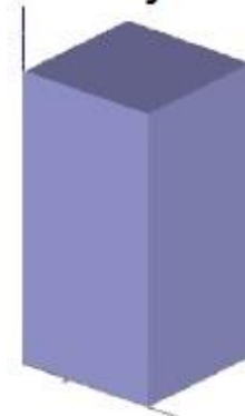
Slika 3.5. Orijentacija ispitnog tijela za ispitivanje pritisnih svojstava [9]
