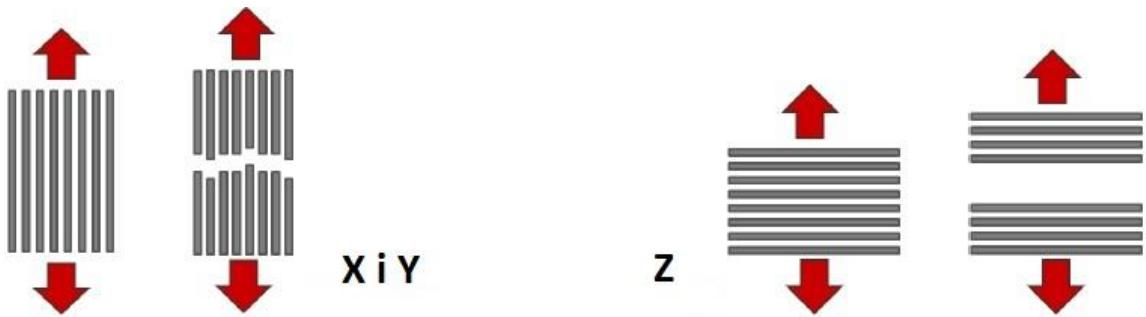
Slika 3.4. Vrsta loma kod ispitivanja tijela u X, Y i Z smjeru [9]
