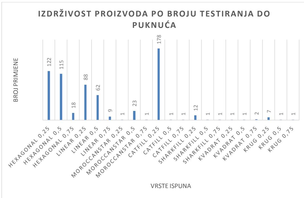
Slika 4.26. Izdrživost proizvoda po broju ispitivanja do puknuća
