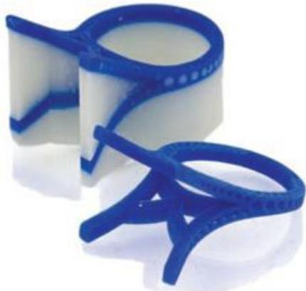
Slika 2.7. Potporni materijal [7]
