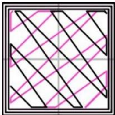
Slika 3.8. Ispuna unutrašnjosti s linijama [10]
