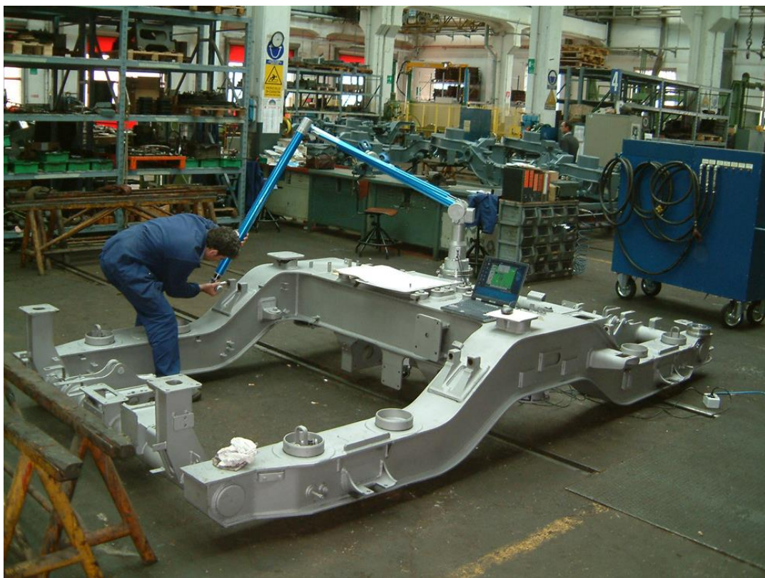
Slika 8. Primjena 3D mjerne ruke u proizvodnji [11]
