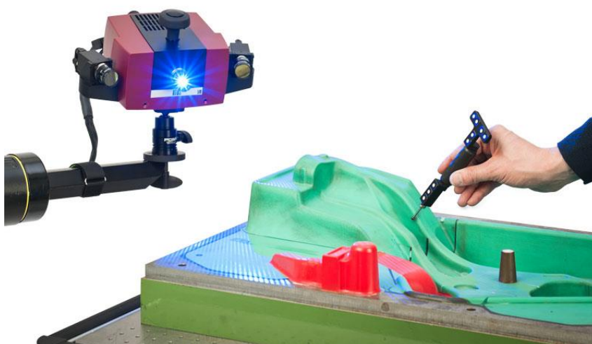
Slika 47. Projekcija uzorka + fotogrametrija + kontaktno mjerenje [56]
