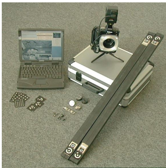
Slika 12. Ručni fotogrametrijski sustav [16]
