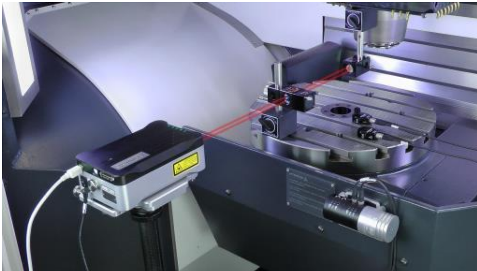
Slika 26. Laserski interferometar za mjerenje linearnog pomaka [33]
