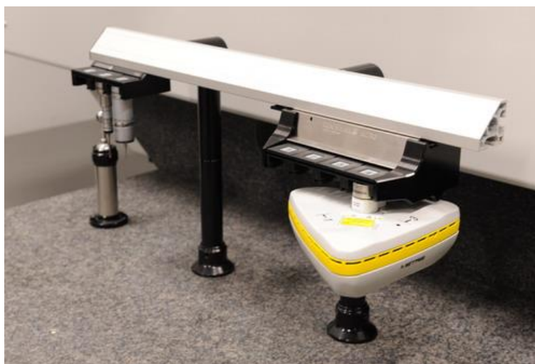
Slika 5. Postolje za promjenu senzora [7]
