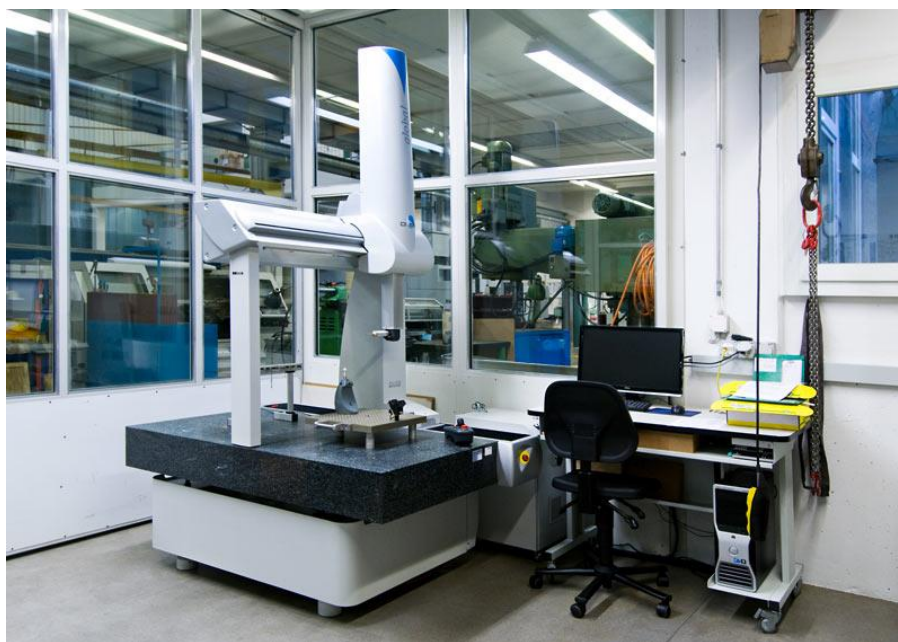
Slika 3. Višesenzorni trokoordinatni mjerni uređaj [5]
