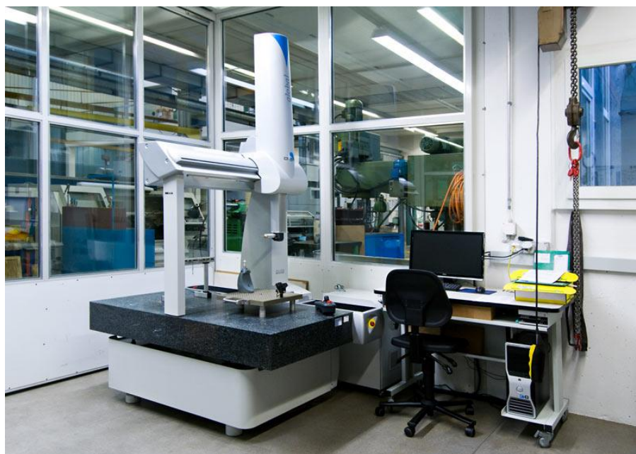
Slika 3. Višesenzorni trokoordinatni mjerni uređaj [5]
