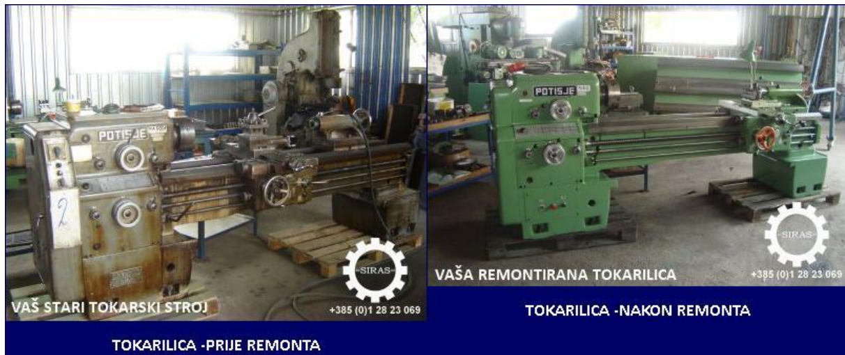
Slika 4. Vizualna usporedba tokarilice prije i nakon remonta
