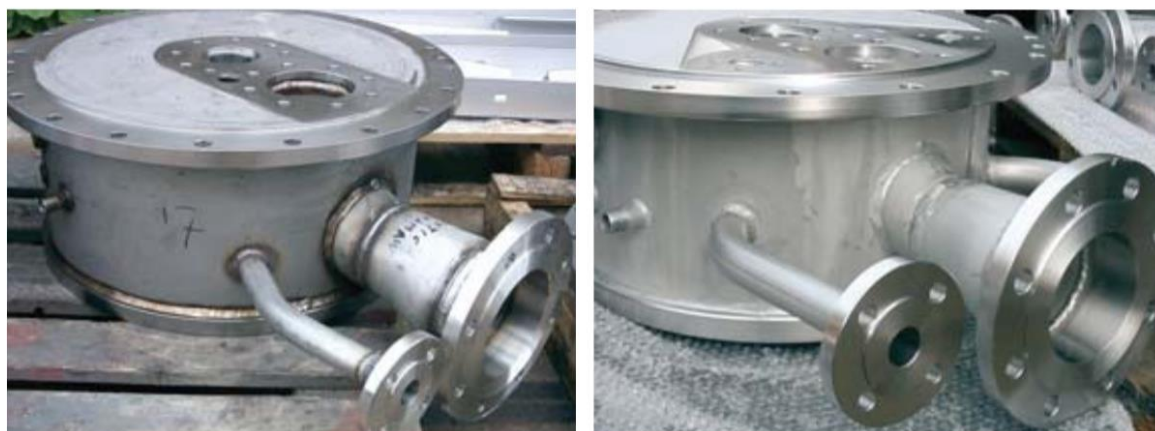
Slika 12. Obradak prije (lijevo) i nakon (desno) nagrizanja u kupki [21]
