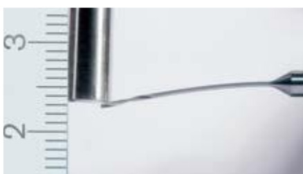
Slika 43 MIKRON CrazyDrill Flex, fleksibilnost mikro svrdla [12]
