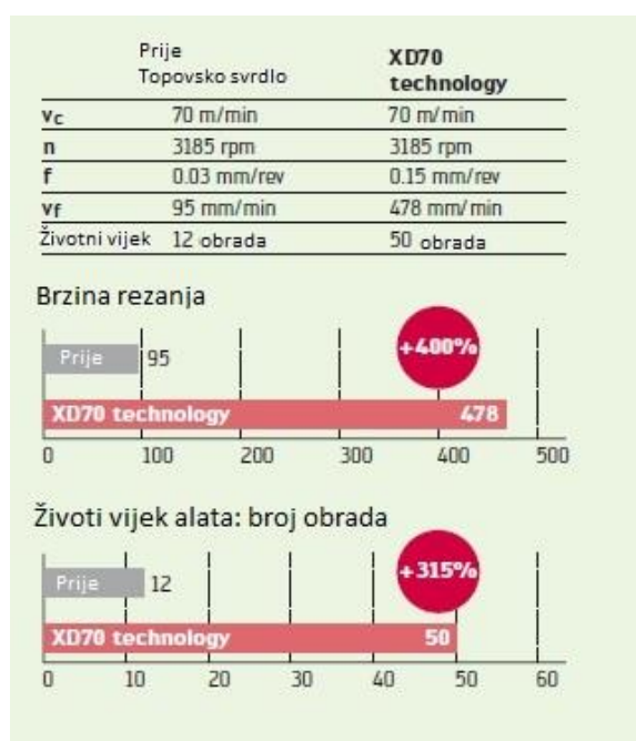
Slika 50 Usporedba Walter Titex XD® Technology i topovskog svrdla [5]
