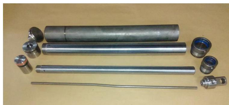
Slika 38: Dijelovi dvoradnog teleskopskog cilindra
