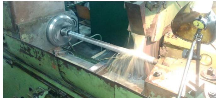
Slika 37: Vanjsko brušenje manje cijevi cilindra
