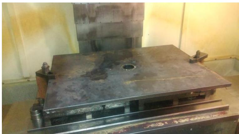
Slika 27: Ploča stegnuta za obradu
