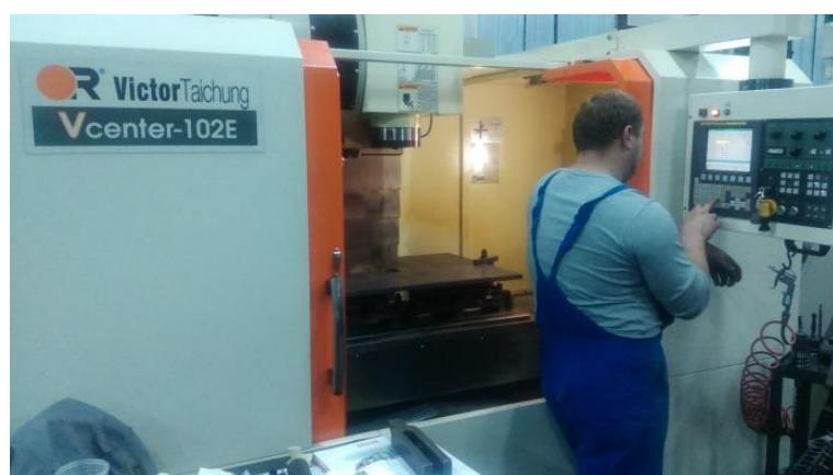
Slika 26: Obradni centar, obrada osnovne ploče
