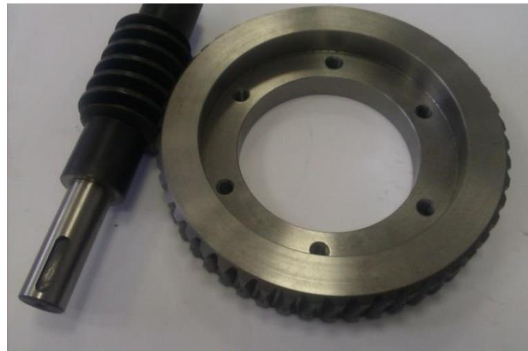
Slika 30: Izrađeno pužno kolo i pužni vijak
