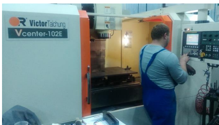
Slika 26: Obradni centar, obrada osnovne ploče
