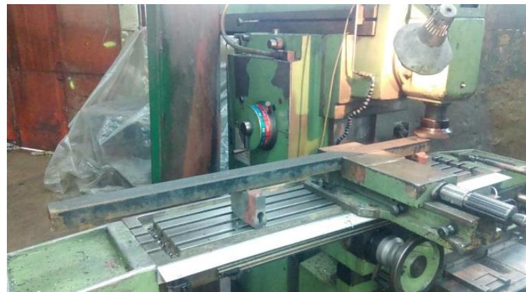
Slika 33: Obrada površine za montažu linearne vodilice
