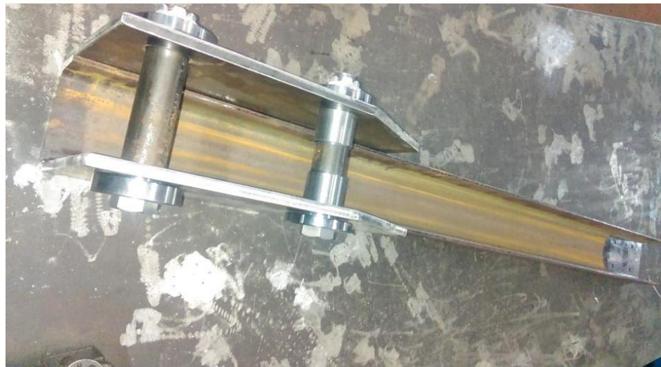
Slika 34: Sklop većeg profila i bočnih ploča
