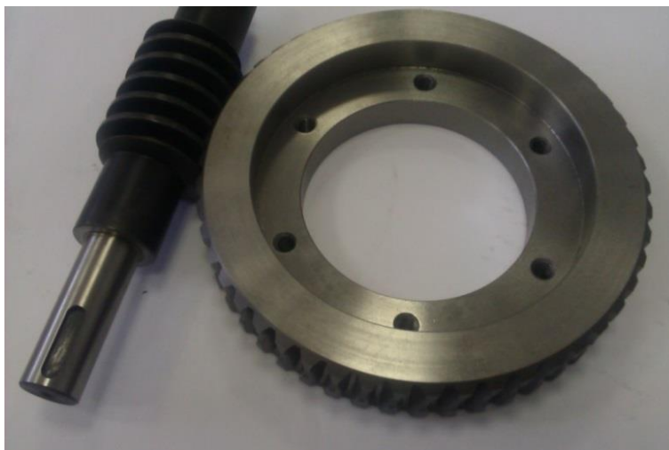
Slika 30: Izrađeno pužno kolo i pužni vijak
