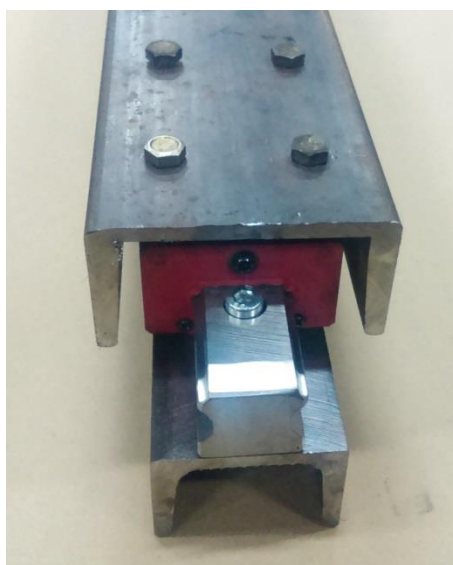
Slika 32: Sklop profila i linearne vodilice
