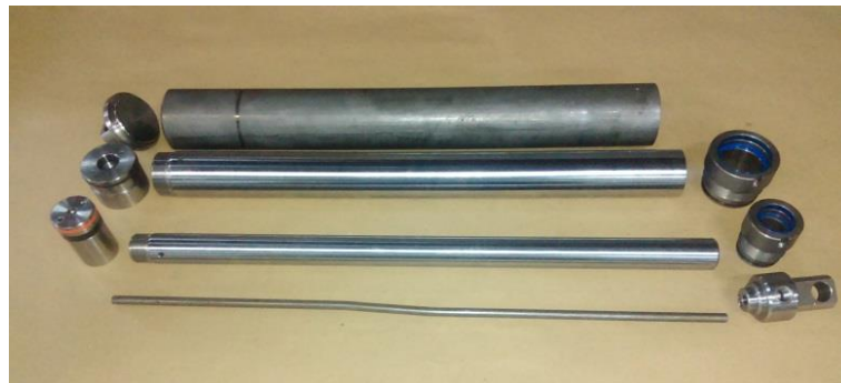
Slika 38: Dijelovi dvoradnog teleskopskog cilindra
