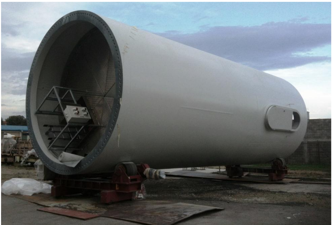
Slika 1.4. Donji segment stupa vjetroagregata K80 [4]
