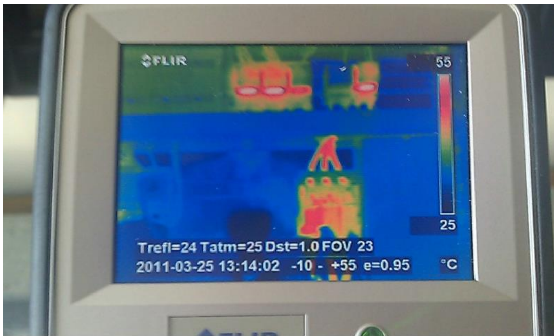
Slika 23. Termovizijsko snimanje razvodne kutije
