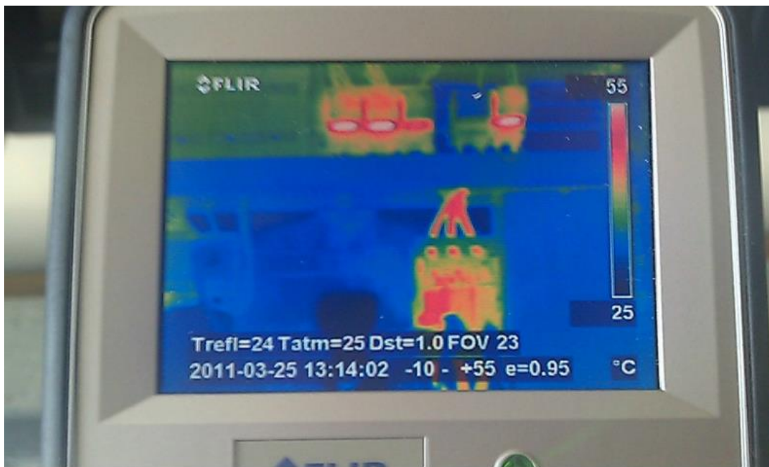
Slika 23. Termovizijsko snimanje razvodne kutije
