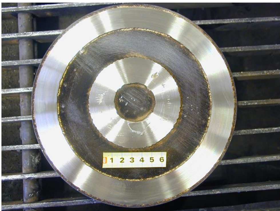
Slika 24 Obradak nakon dodatne obrade tokarenja [18]
