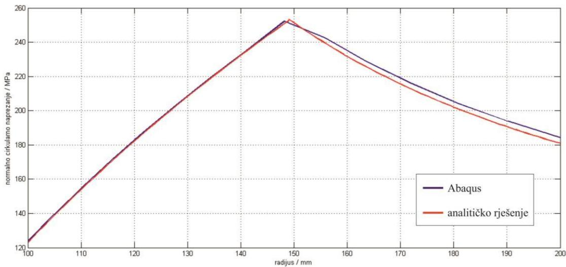
Slika 34. Usporedba analitičkog i numeričkog rješenja raspodjele normalnog cirkularnog naprezanja za slučaj optimalne autofretaže
