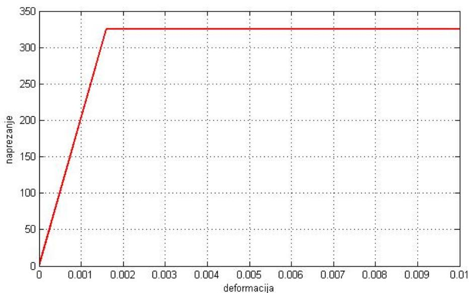
Slika 23. Dijagram naprezanje - istezanje elastičnog - idealno plastičnog materijala
