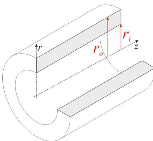
Slika 1. Geometrija debelostijene cijevi u cilindričnom koordinatnom sustavu
