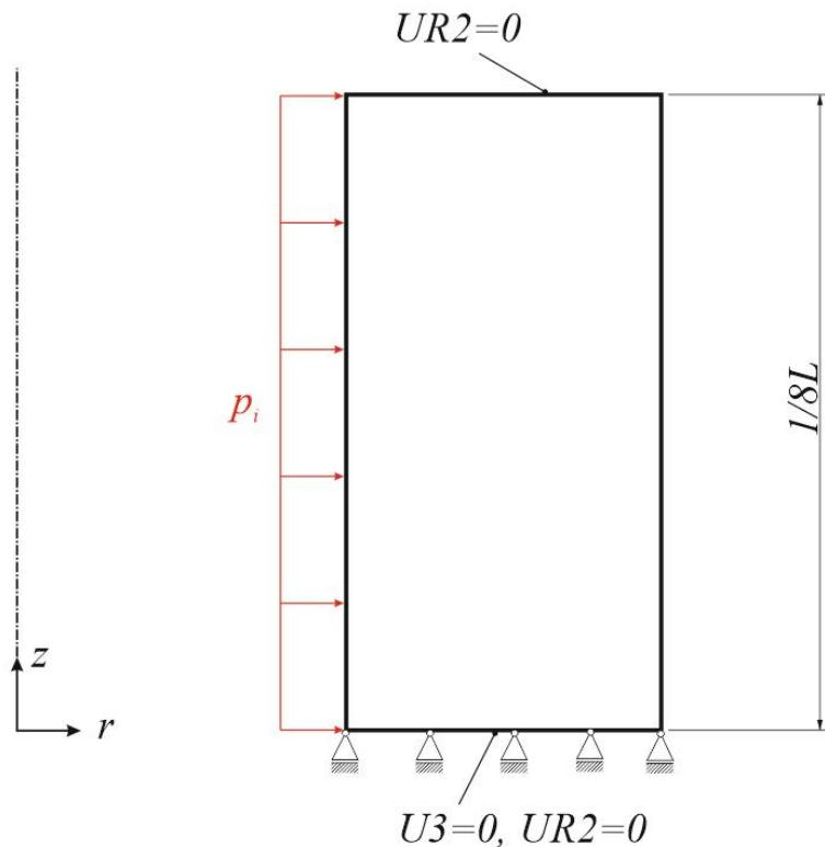
**Slika 15. Proračunski osnosimetrični model u paketu Abaqus**
