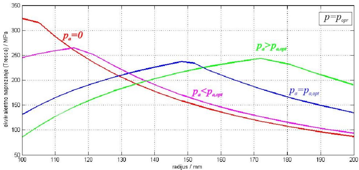
Slika 33. Usporedba ekvivalentnog naprezanja pri radnom opterećenju za različite slučajeve autofretaže
