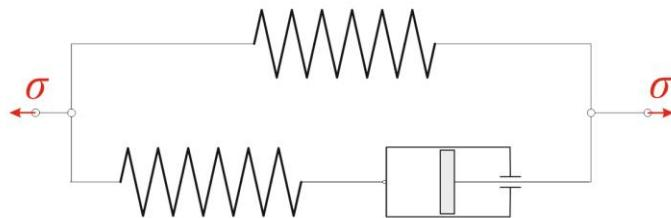
Slika 39. Shematski prikaz Zenerovog modela viskoelastičnog materijala
