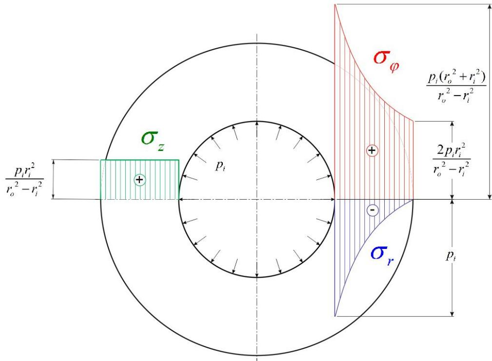
Slika 9. Raspodjela normalnih naprezanja po presjeku cijevi
