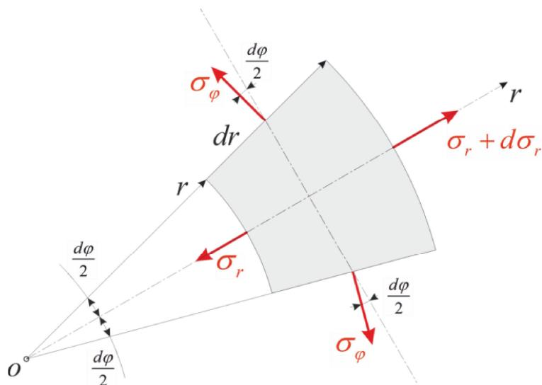
Slika 8. Diferencijalni element debelostjene cijevi
