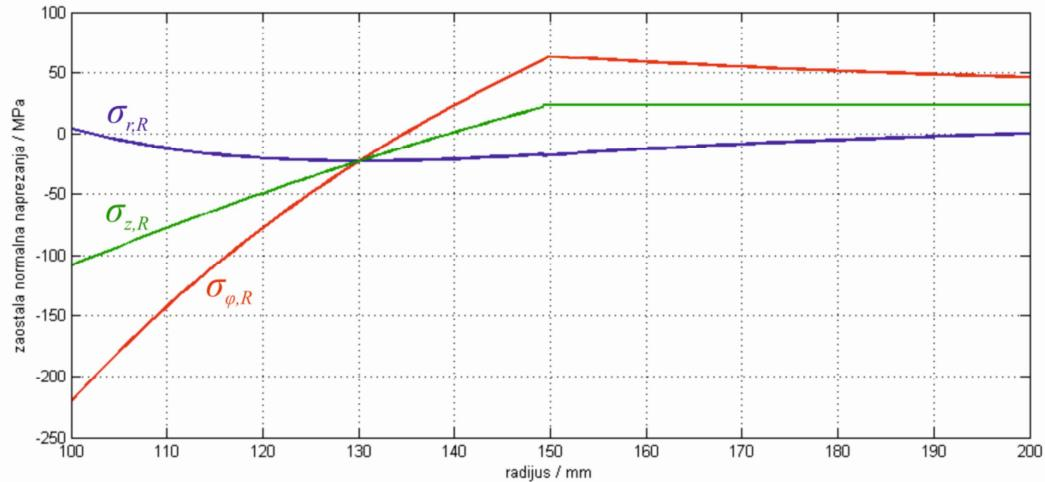
Slika 27. Raspodjela zaostalih normalnih naprezanja nakon optimalne autofretaže
