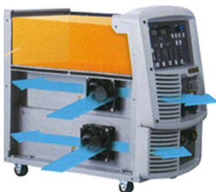
Slika 18. Protok zraka kroz Welbee izvor struje [16]
