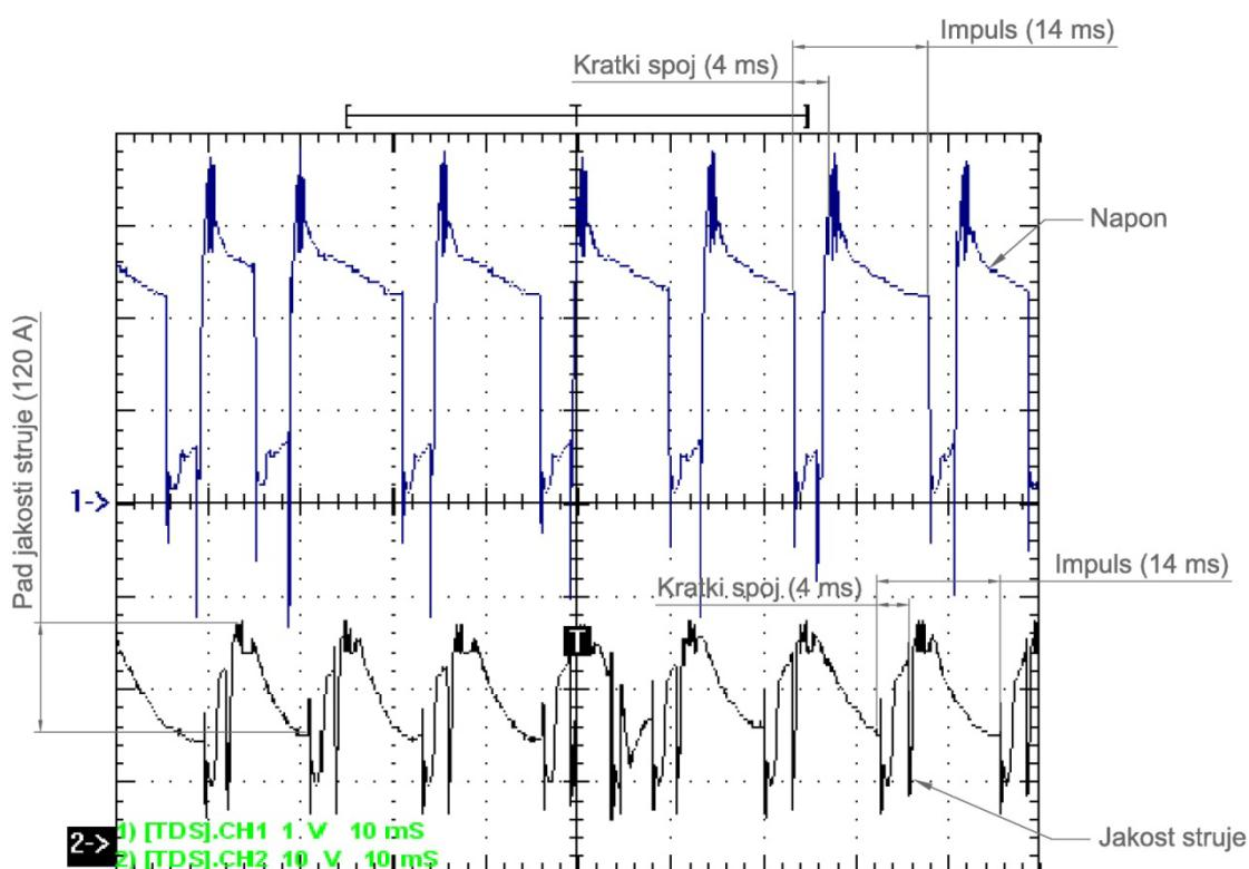
**Slika 28. Oscilogram dinamičke karakteristike  $u,i = f(t)$ , pri CBT prijenosu metala pri brzini dodavanja žice 5 m/min (82 % Ar / 18 % CO<sub>2</sub>)**
