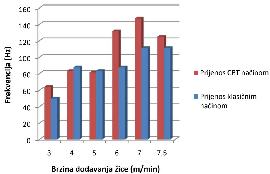
Slika 35. Grafikon usporedbe frekvencija kod CBT i klasičnog načina prijenosa u ovisnosti o brzini dodavanja žice u zaštitnoj atmosferi 82 % Ar / 18 % CO<sub>2</sub>
