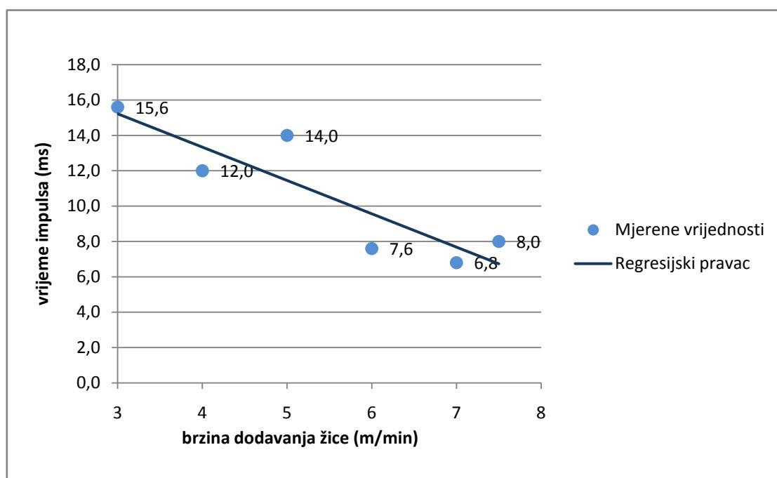
**Slika 33. Promjena vremena trajanja impulsa u ovisnosti od brzine dodavanja žice kod modificiranog CBT načina prijenosa metala (82 % Ar / 18 % CO<sub>2</sub>)**
