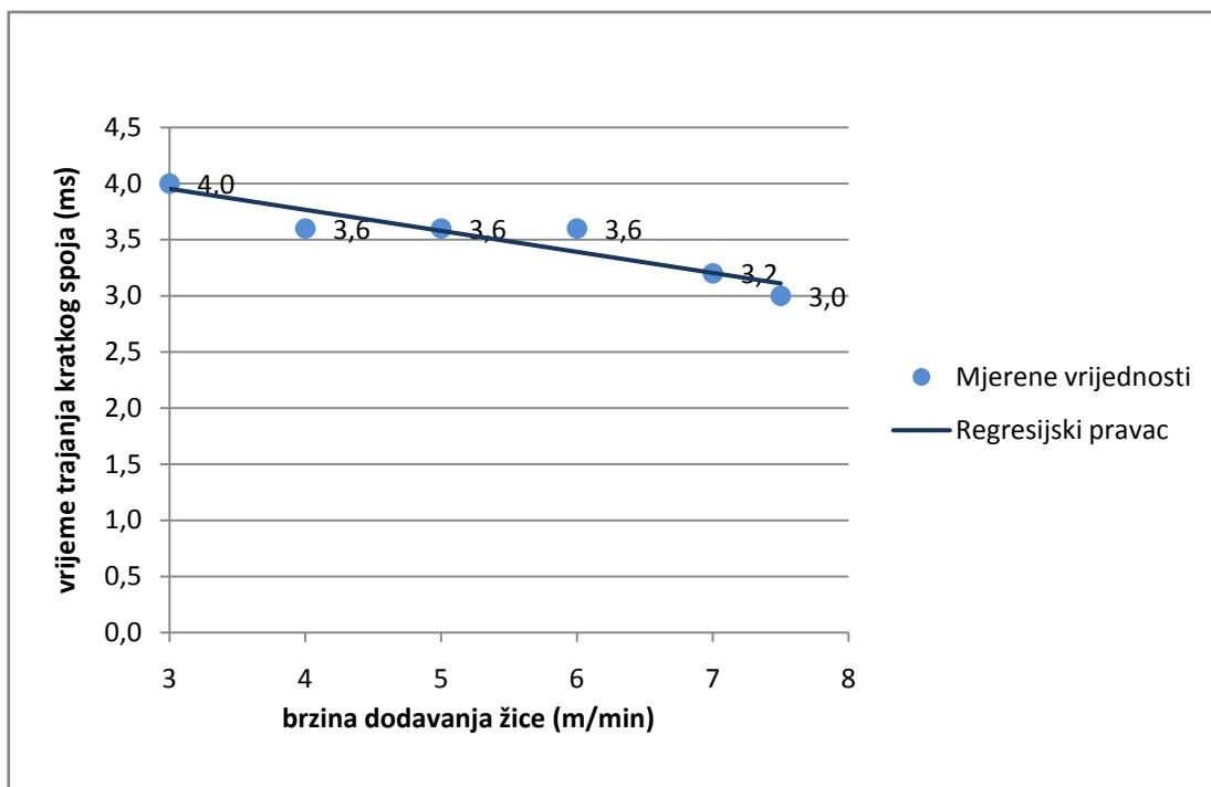
**Slika 34. Promjena vremena trajanja kratkog spoja u ovisnosti od brzine dodavanja žice kod modificiranog CBT načina prijenosa metala (82 % Ar / 18 % CO<sub>2</sub>)**
