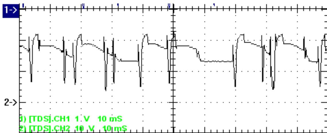
Slika 48. Oscilogram dinamičke karakteristike  $i = f(t)$ , pri klasičnom prijenosu metala pri brzini dodavanja žice 5 m/min (82 % Ar / 18 %  $\text{CO}_2$ )
