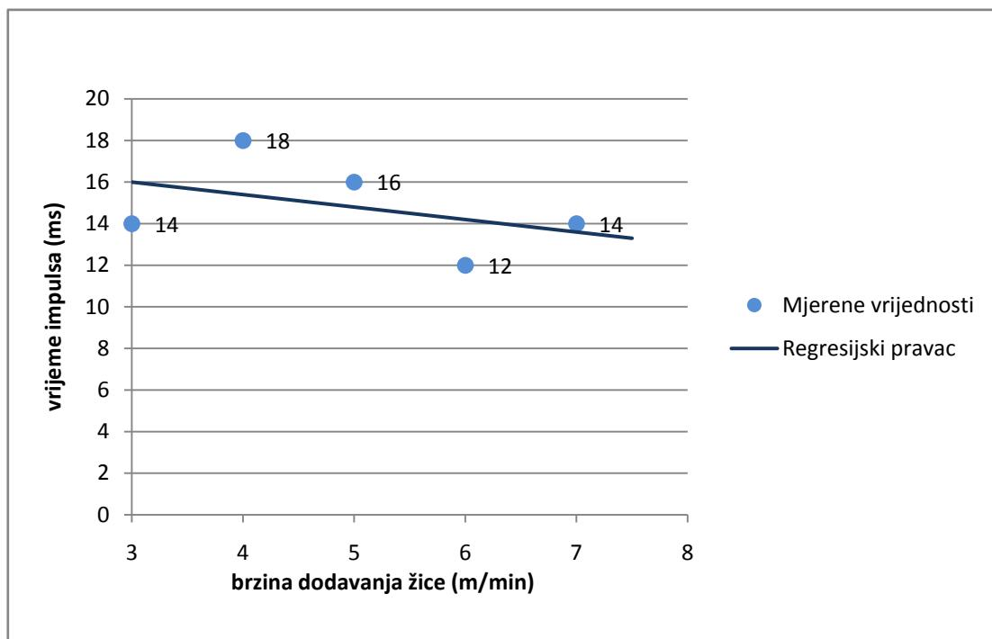
**Slika 42. Promjena vremena trajanja impulsa u ovisnosti od brzine dodavanja žice kod modificiranog CBT načina prijenosa metala (100% CO<sub>2</sub>)**
