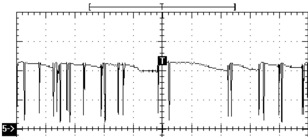
Slika 47. Oscilogram dinamičke karakteristike  $i = f(t)$ , pri modificiranom CBT prijenosu metala pri brzini dodavanja žice 8 m/min (82 % Ar / 18 %  $\text{CO}_2$ )
