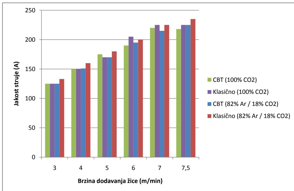
**Slika 45.** Grafikon vrijednosti jakosti struja zavarivanja u ovisnosti o brzini dodavanja žice
