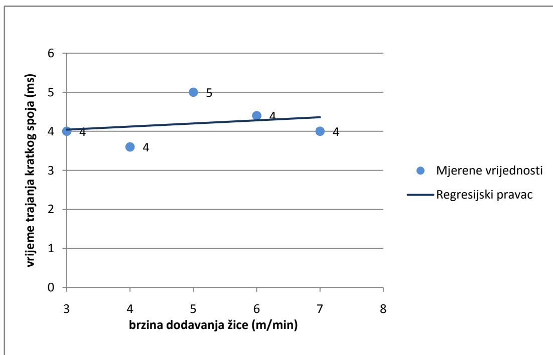
**Slika 43. Promjena vremena trajanja perioda kratkih spojeva u ovisnosti od brzine dodavanja žice kod modificiranoga CBT načina prijenosa metala (100% CO<sub>2</sub>)**
