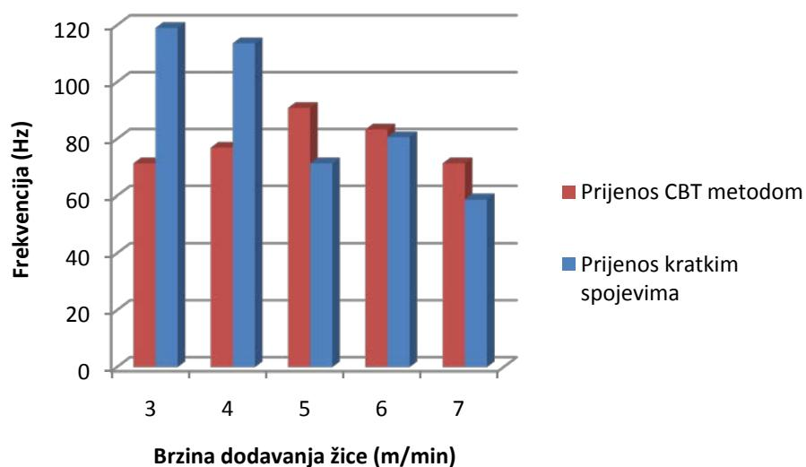
**Slika 44. Grafikon usporedbe frekvencija kod CBT i klasičnog načina prijenosa u ovisnosti o brzini dodavanja žice u zaštitnoj atmosferi 100 % CO<sub>2</sub>**
