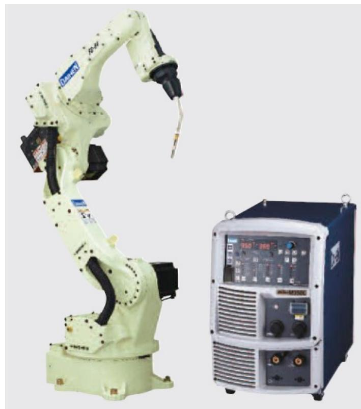
Slika 19. Welbee digitalni inverter P500L s robotskom rukom [14]
