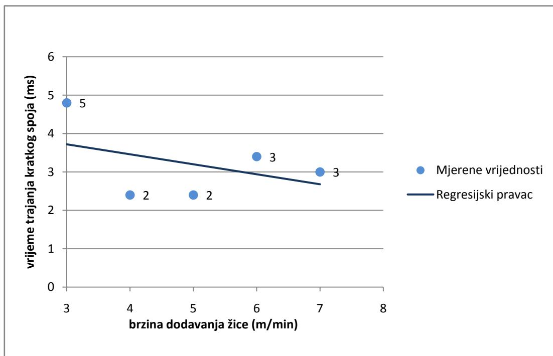
**Slika 41. Promjena vremena trajanja perioda kratkih spojeva u ovisnosti od brzine dodavanja žice kod klasičnoga načina prijenosa metala (100% CO<sub>2</sub>)**
