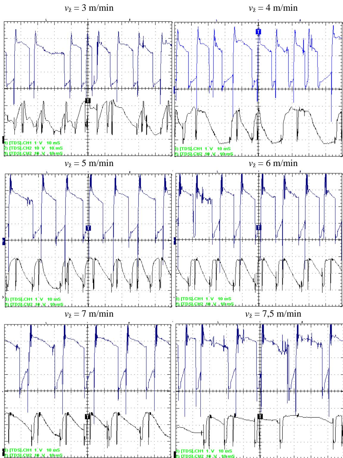
**Slika 36. Oscilogrami dinamičkih karakteristika  $u,i = f(t)$ , pri modificiranom CBT prijenosu metala (100%  $\text{CO}_2$ )**
