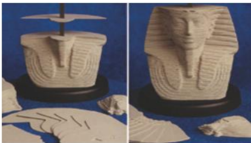
Slika 3.1. Princip izrade proizvoda: a.) prikaz slaganja slojeva, b.) prikaz 3D tvorevine [6]
