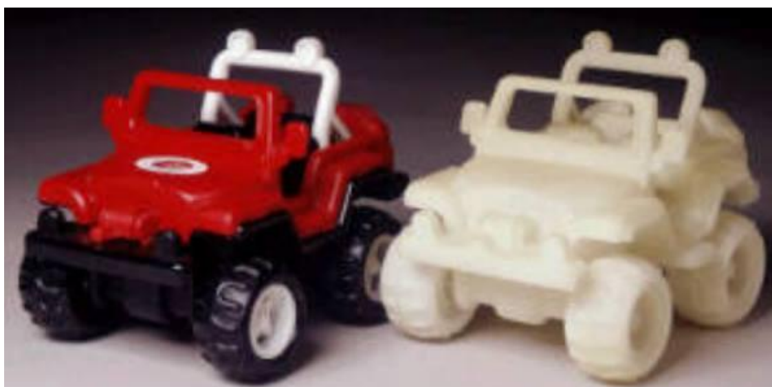
Slika 3.12. Primjeri prototipova dobiveni SGC-om [7]
