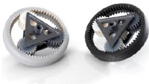
Slika 3.9. Prototipovi dobiveni polyjet-om [9]
