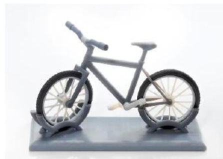
Slika 3.9. Prototipovi dobiveni polyjet-om [9]
