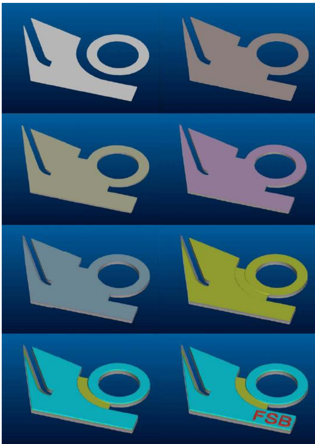
Slika 4.8. Izrada tvorevine sloj po sloj [17]
