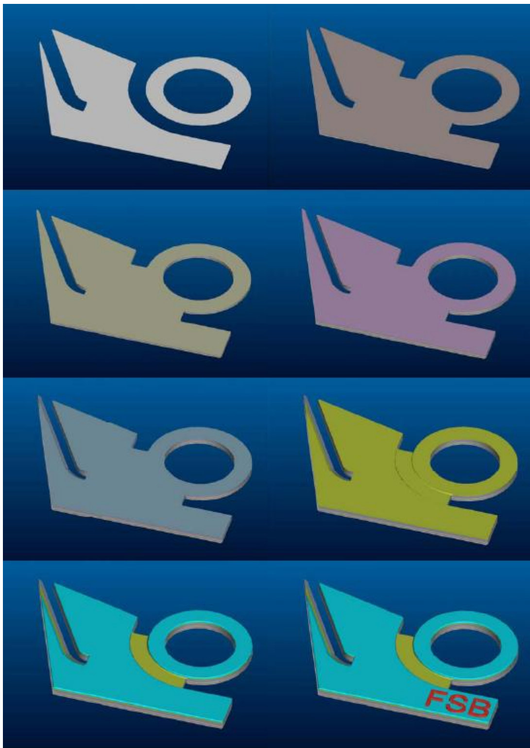
Slika 4.8. Izrada tvorevine sloj po sloj [17]
