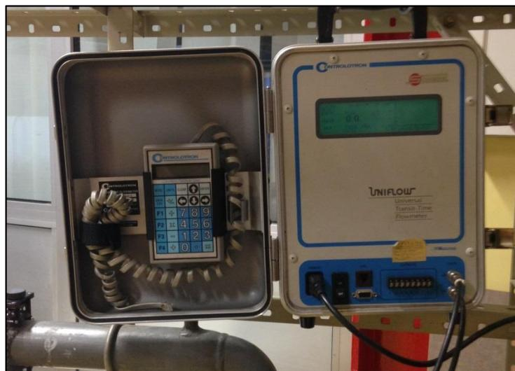
Slika 14. Ultrazvučni protokomjer
