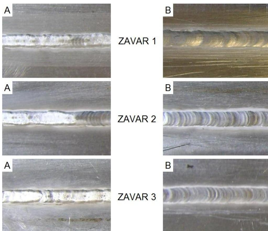
Slika 4.10. Tri obostrano (A i B) napravljena zavara
