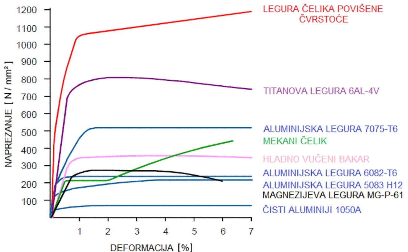
Slika 2.1. Hooke-ov dijagram aluminijskih legura i ostalih metalnih materijala [1]
