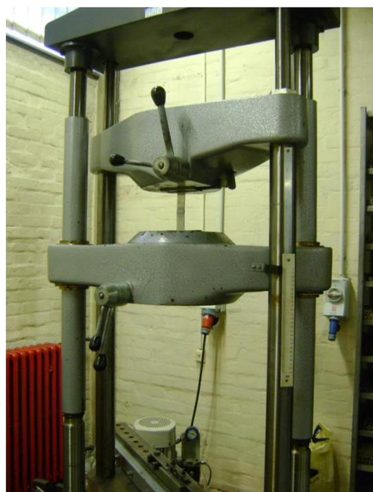
Slika 4.18. Epruveta u čeljustima kidalice
