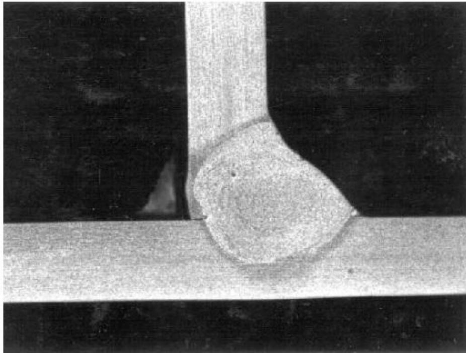
Slika 3.6. Kutni zavar 6 mm debelih limova napravljen TIG postupkom s helijem kao zaštitnim plinom [2]
