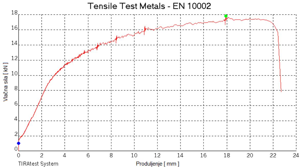
Slika 4.20. Dijagram vlačna sila - produljenje za epruvetu 2
