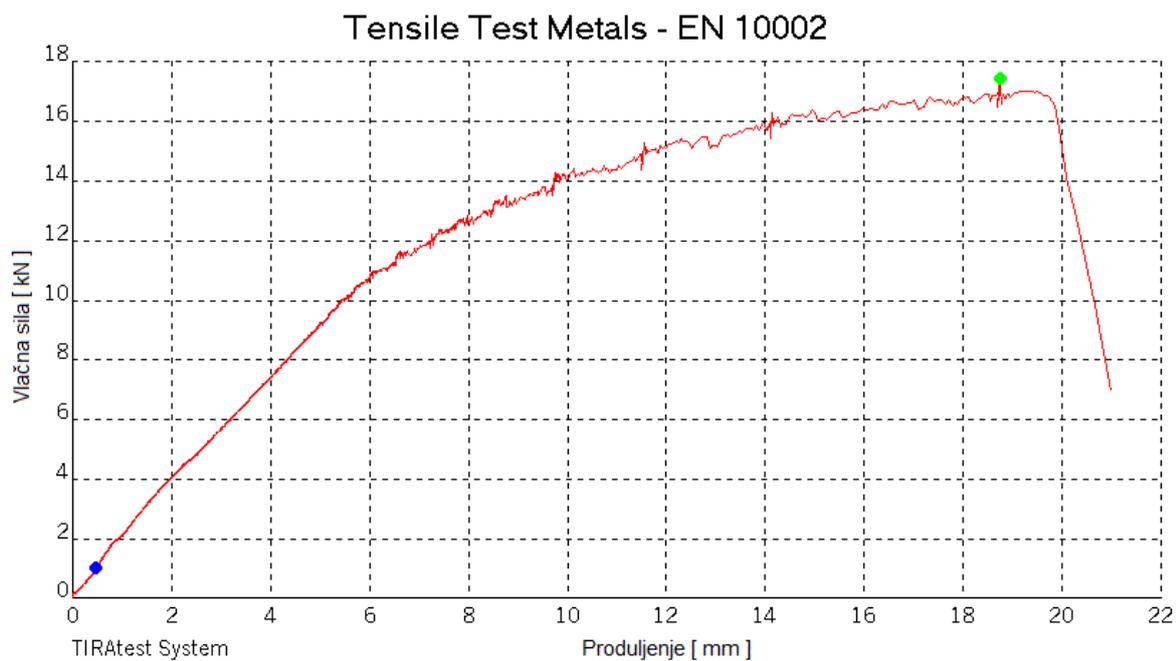
Slika 4.21. Dijagram vlačna sila - produljenje za epruvetu 3
