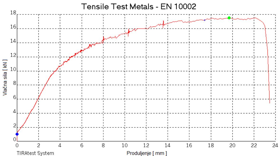
Slika 4.19. Dijagram vlačna sila - produljenje za epruvetu 1
