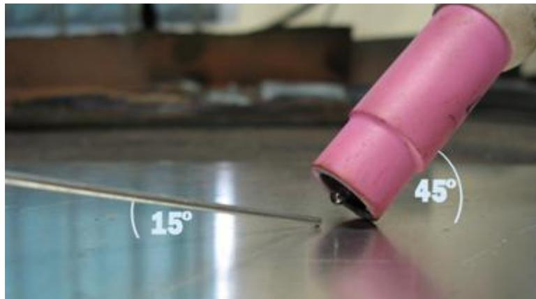
Slika 4.6. Primjer nagiba elektrode kod TIG postupka zavarivanja [7]
