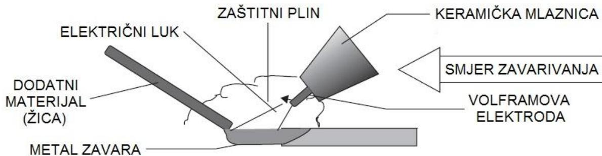
Slika 3.1. Shematski prikaz TIG postupka zavarivanja [2]
