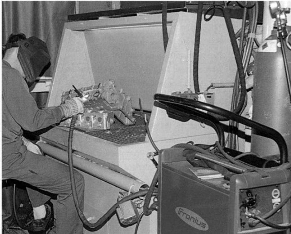
Slika 3.2. Osnovna oprema za TIG postupak zavarivanja [2]
