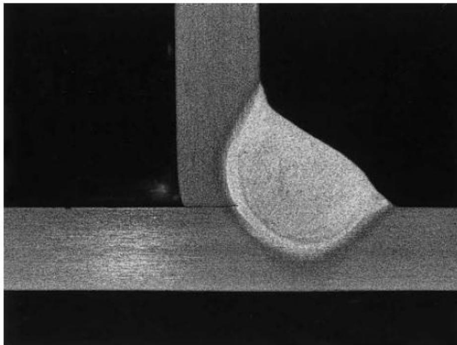
Slika 3.5. Kutni zavar 6 mm debelih limova napravljen TIG postupkom s argonom kao zaštitnim plinom [2]
