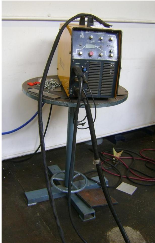
Slika 4.7. TINY 170AC/DC uređaj za TIG zavarivanje
