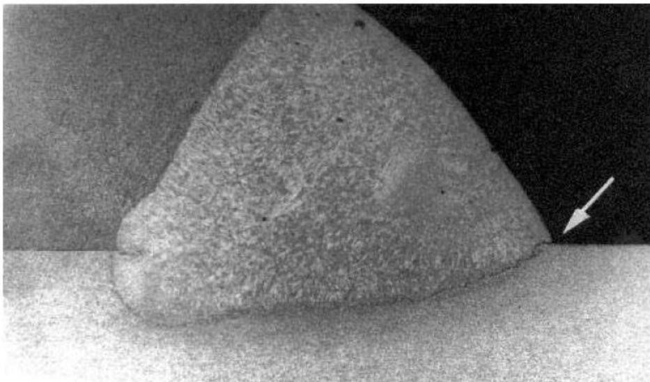
Slika 2.9. Oksidni film u metalu zavara [2]
