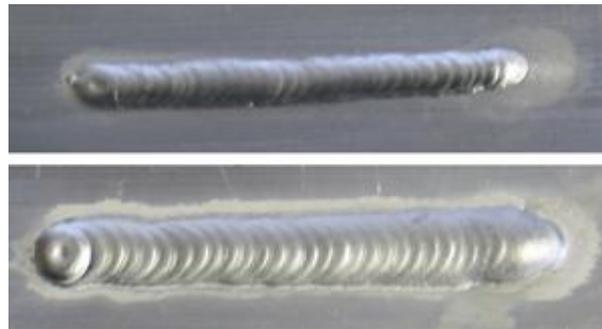
Slika 4.4. Zavari napravljeni s različitim frekvencijama izmjenične struje [6]
