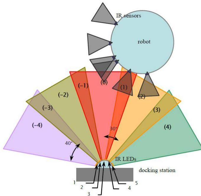
Slika 2. Sustav za navođenje razdijeljen na regije pomoću dioda[1]
