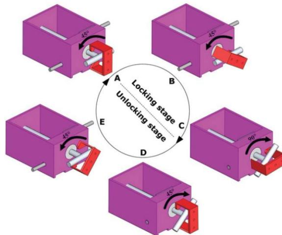
Slika 27. Pet stupnjeva zaključavanja i otključavanja kućišta[8]
