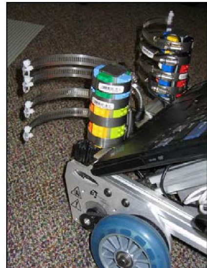
Slika 10. Stanica za punjenje i mehanizam na robotu[5]
