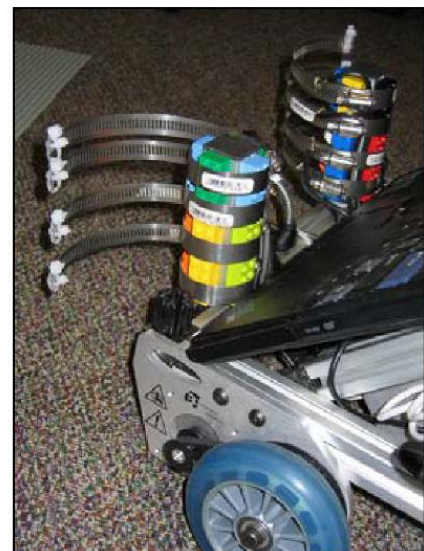
Slika 10. Stanica za punjenje i mehanizam na robotu[5]
