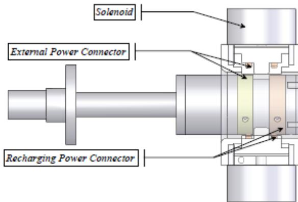
Slika 17. Mehanizam spajanja[6]
