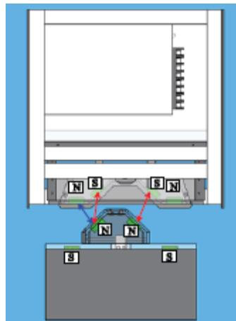
**Slika 19.** Korištenje magnetskih sila za ispravljanje robota[6]
