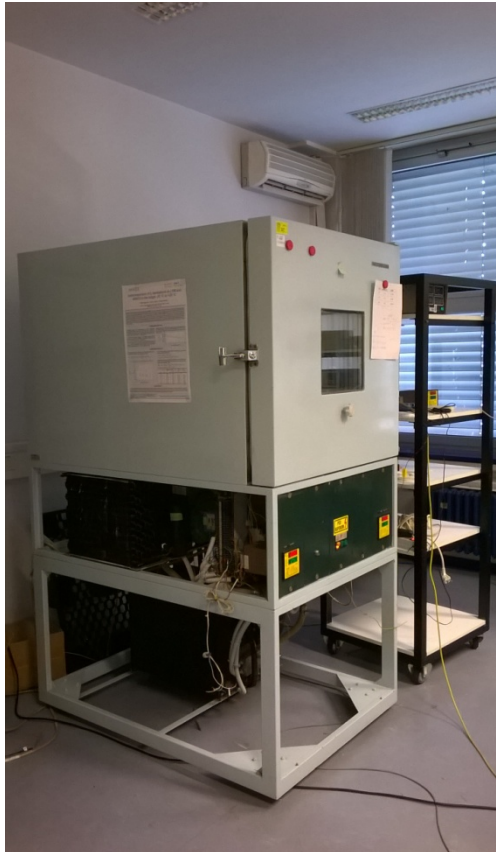
Slika 16 Termostatska komora na kojoj je vršeno umjeravanje
