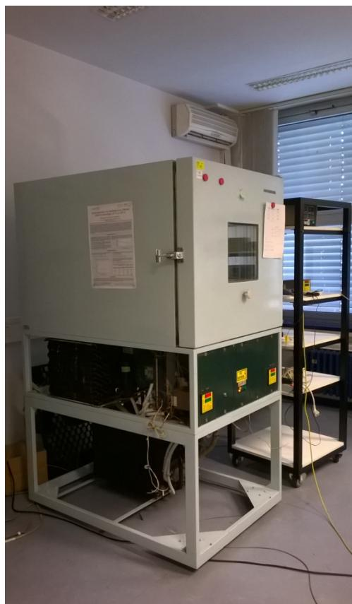
**Slika 16 Termostatska komora na kojoj je vršeno umjeravanje**
