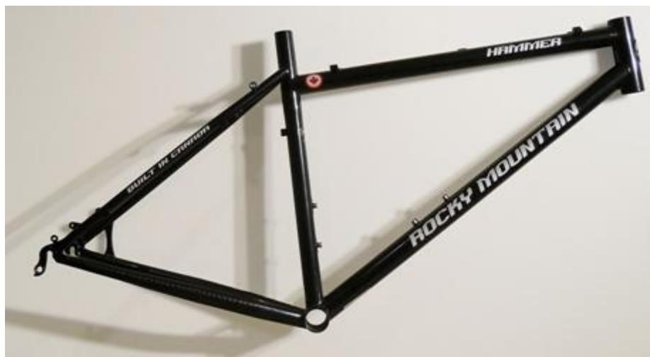
Slika 14. Izgled "tvrdorepog" (HT) okvira bicikla [21]
