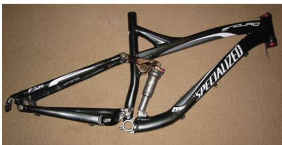
Slika 15. Izgled okvira za bicikl s dvostrukim ovjesom (FS) [22]
