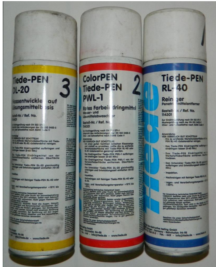
Slika 22. Oprema za ispitivanje penetrantom
