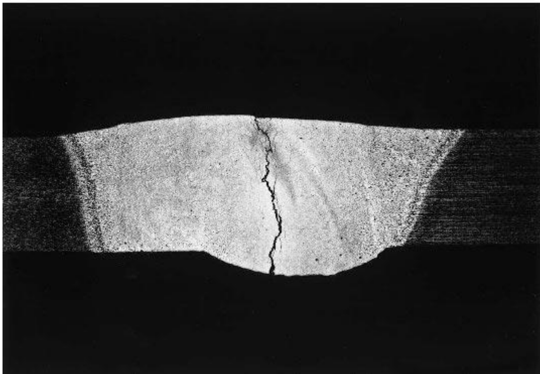
Slika 6. Tople pukotine: (a) U završetku TIG zavora u leguri A5083; (b) u sučeonom spoju 3mm debelih ploča legure A6082 sa dodatnim materijalom 4043, TIG postupak [1]
