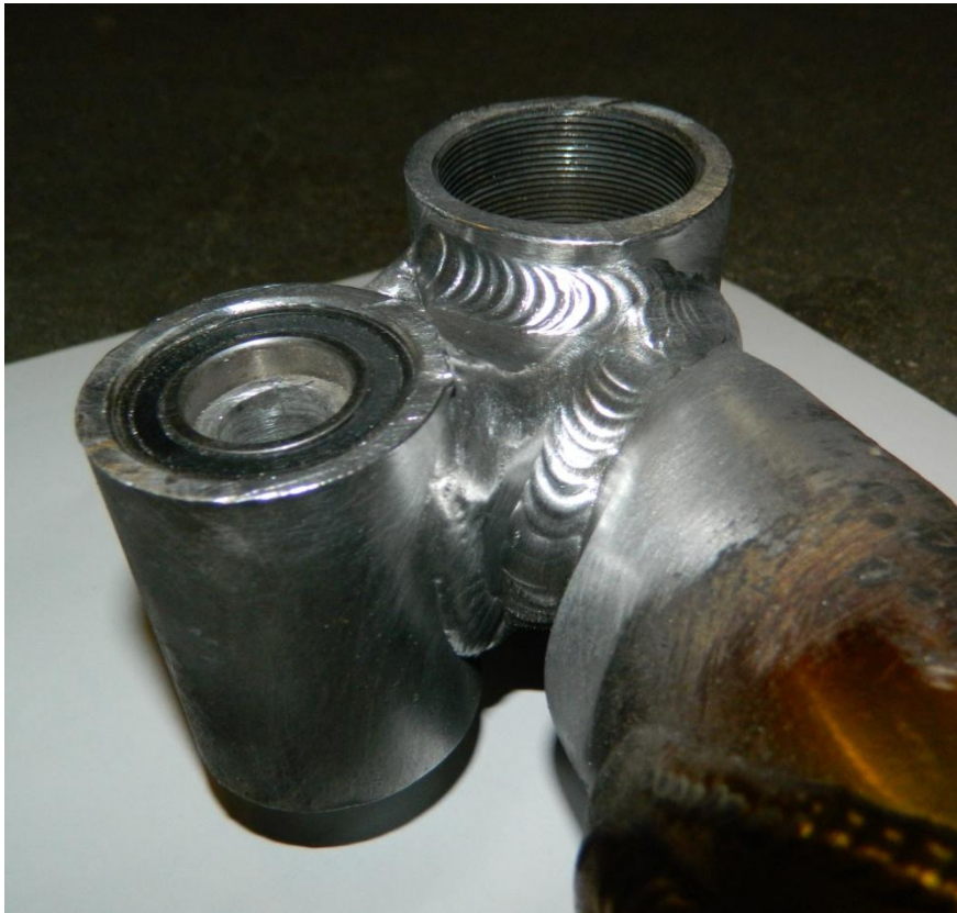
Slika 21. Mehanički očišćen zavar prije ispitivanja penetrantima
