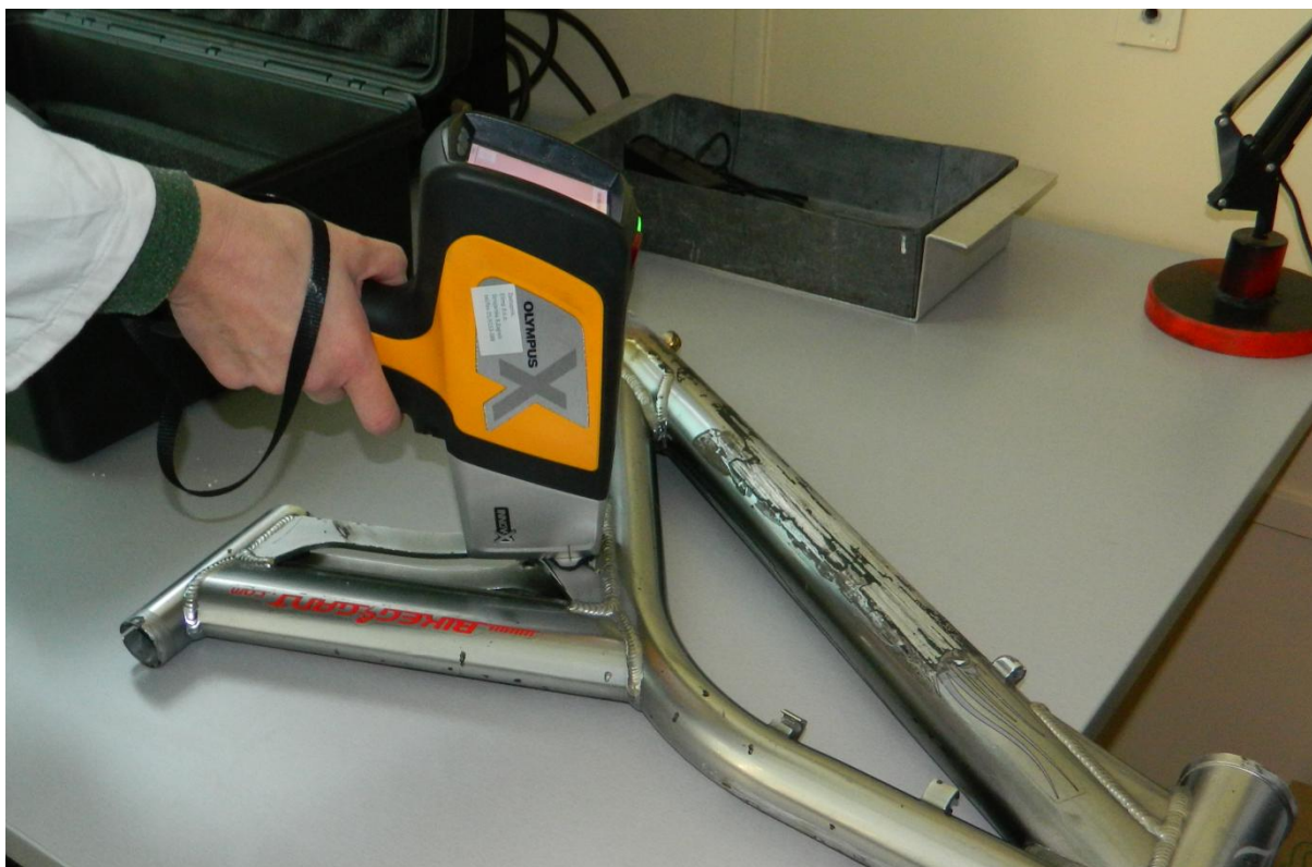
Slika 20. Određivanje masenog udjela kemijskih elemenata ručnim uređajem Olympus XRF
