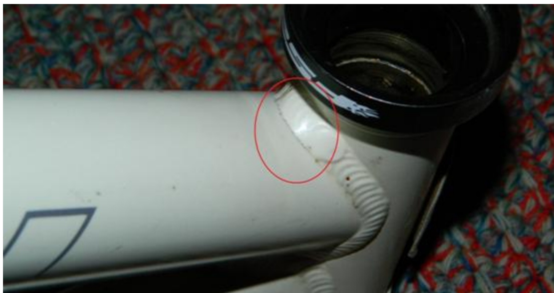
Slika 12. Prikaz pukotine na vlastitom okviru bicikla (spoj donje i prednje cijevi)
