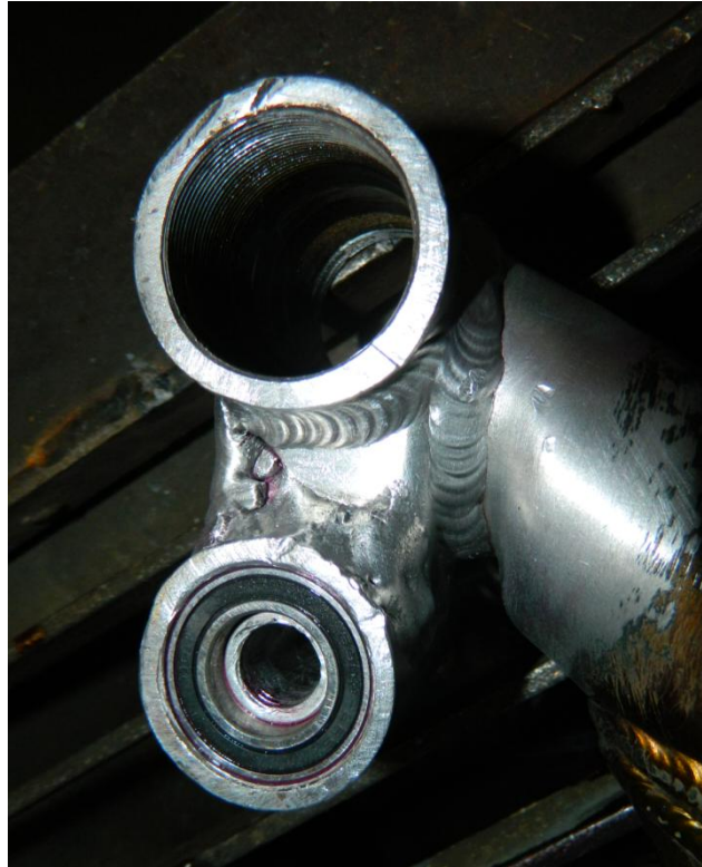
Slika 24. Zavar nakon što je vodom ispran penetrant
