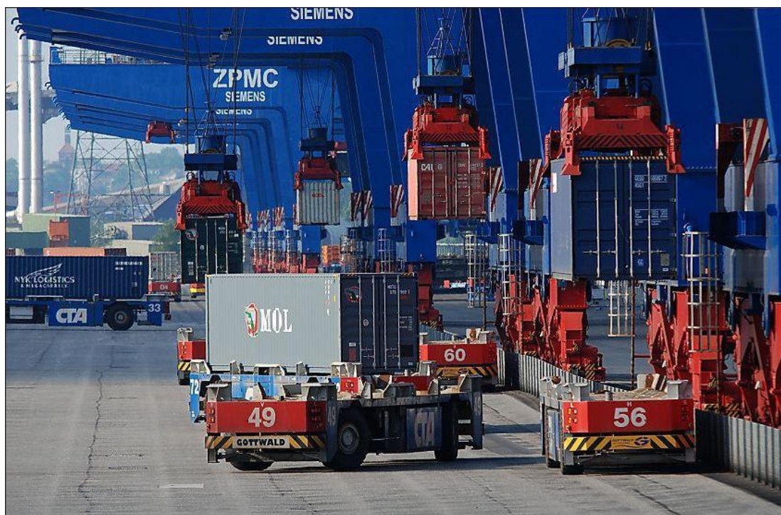
Slika 39. AGV sustav u brodskoj luci [16]
