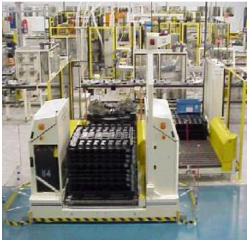
Slika 32. AGV u automobilskoj industriji [25]
