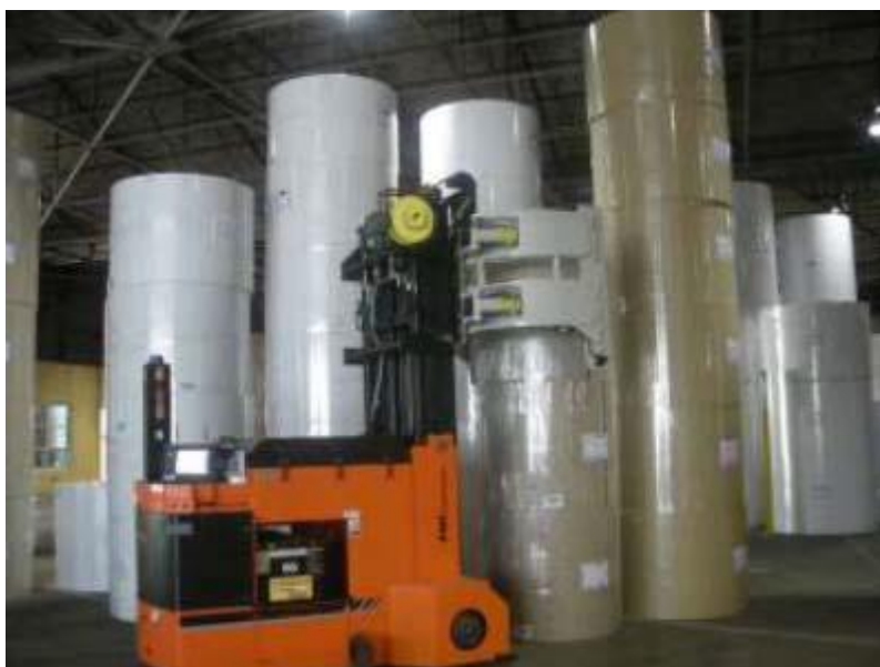
Slika 11. AGV vozilo za transport papirnatih rola [3]
