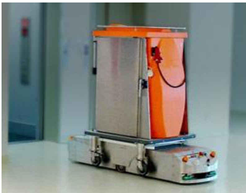
Slika 41. Bolničko AGV vozilo [20]
