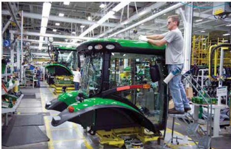
Slika 44. AGV vozila u procesu montaže [16]
