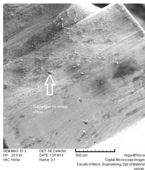
Slika 48. Rezna površina uzorka 3
