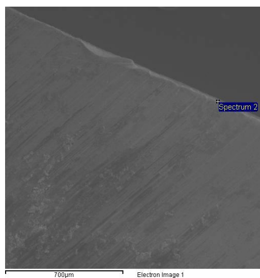
Slika 60. EDS analiza naljepljina na bočnoj površini uzorka 5
