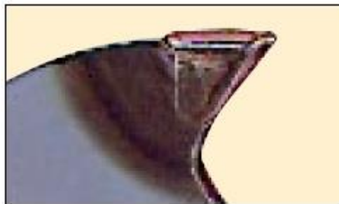
Slika 19. Plazmom zavareni vrh zuba.
