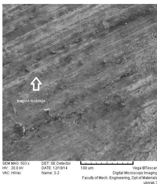
Slika 49. Tragovi trošenja rezne površine uzorka 3
