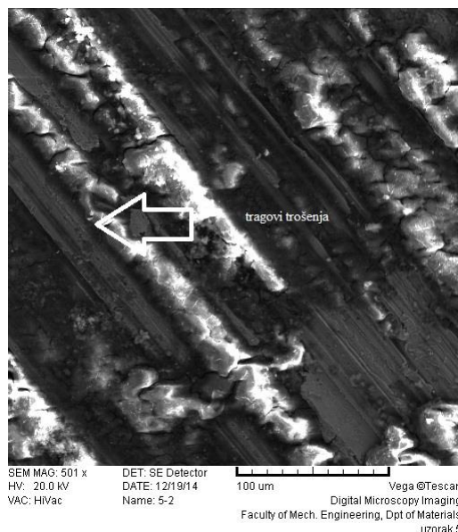
Slika 58. Tragovi trošenja rezne površine uzorka 5
