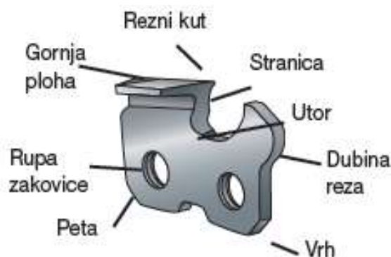
Slika 18. Karakteristični elementi reznog zuba [9]
