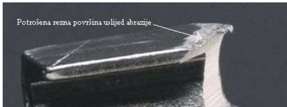
Slika 28. Rezultat abrazivnog trošenja rezne površine reznog zuba
