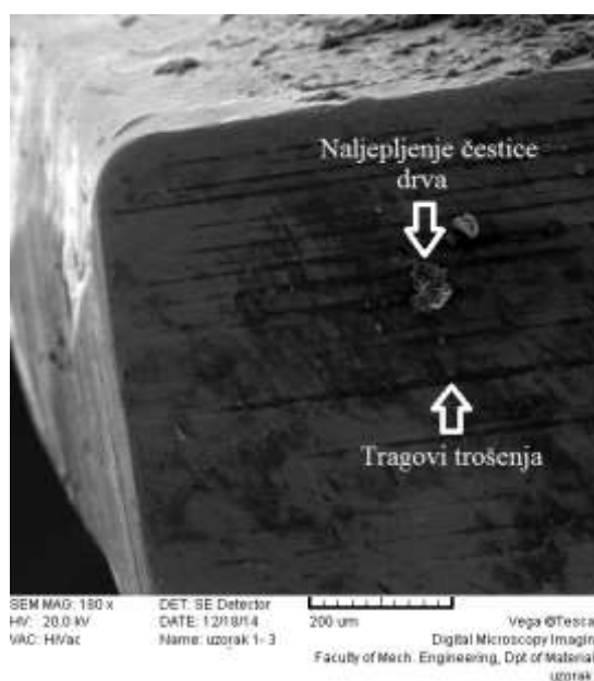
Slika 36. Trošenje rezne površine zuba uzorka 1
