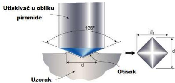
Slika 46. Utiskivač i otisak kod Vickersovog ispitivanja[16]
