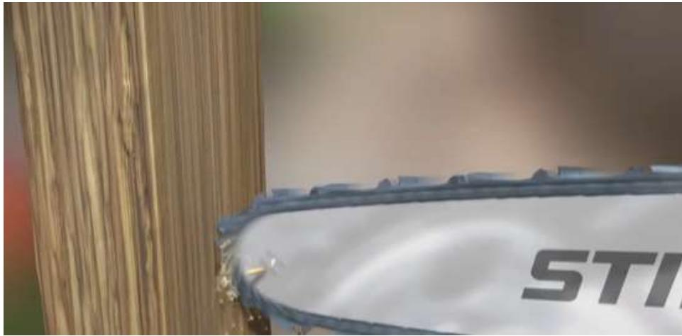
Slika 24. Test na povratni udar [10]
