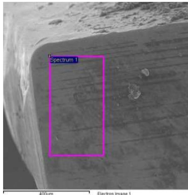
Slika 38. EDS analiza osnovnog materijala uzorka 1
