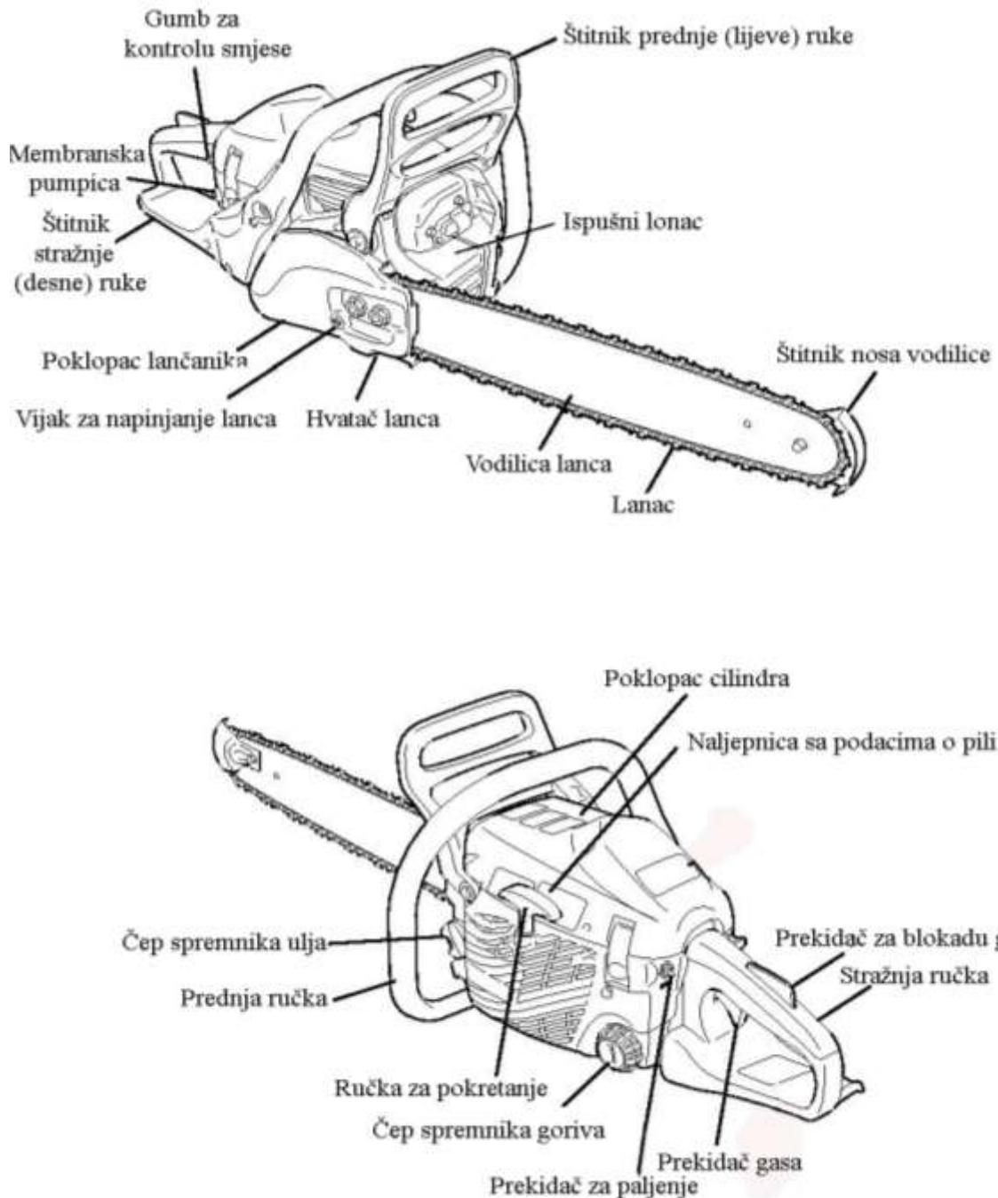
Slika 8. Opći dijelovi motorne pile[4]
