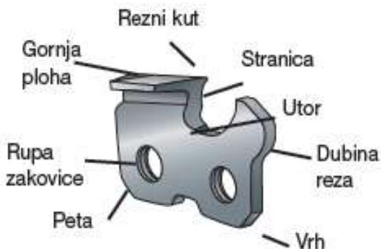
Slika 18. Karakteristični elementi reznog zuba [9]
