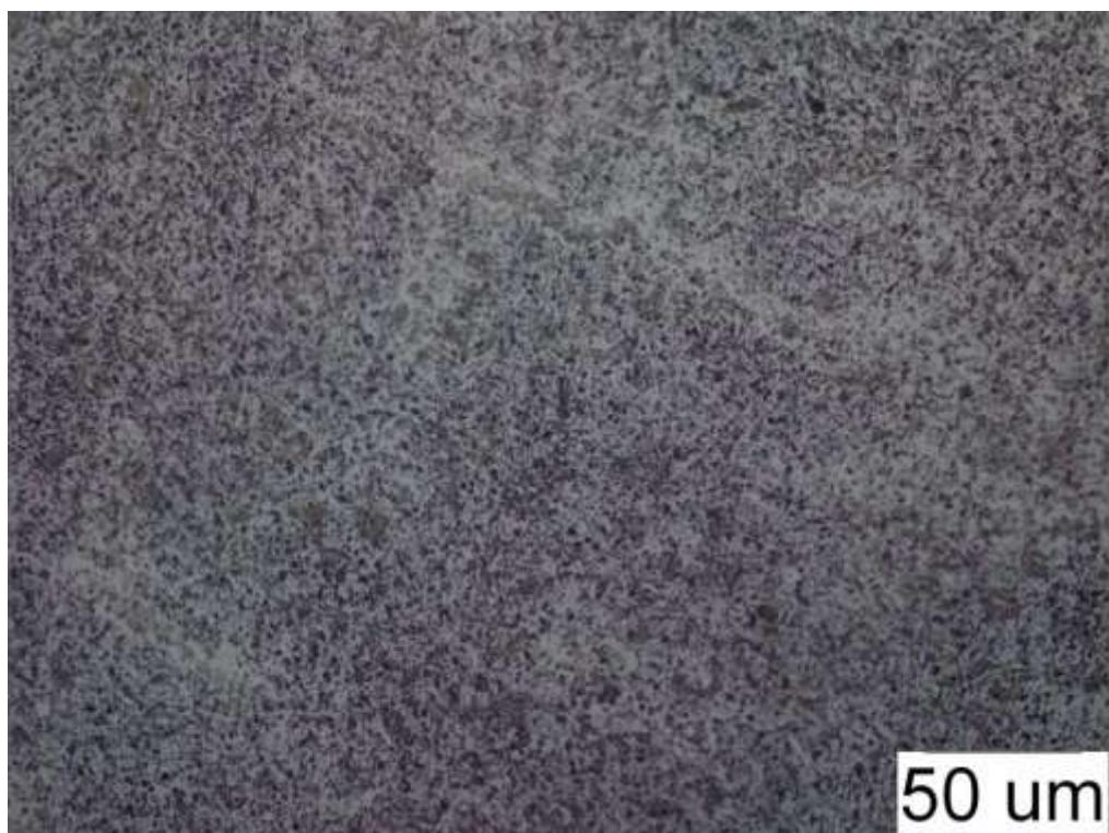
Slika 50. Mikrostruktura reznog člana uzorka 1 (povećanje 500 puta)
