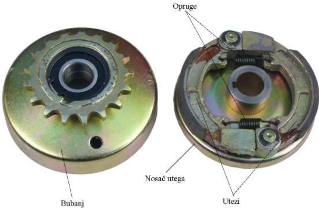
Slika 11. Prikaz dijelova centrifugalne spojke [7]
