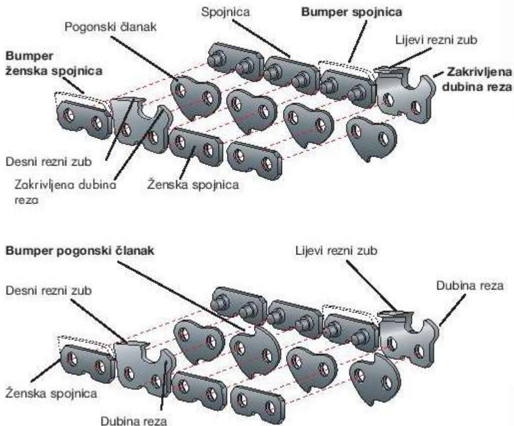
Slika 17. Osnovni elementi reznog lanca motorne pile [9]
