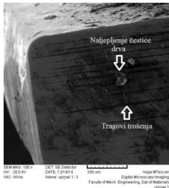
Slika 36. Trošenje rezne površine zuba uzorka 1
