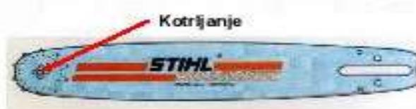
Slika 14. Vodilica sa zakretnom zvjezdом na vrhu [6]
