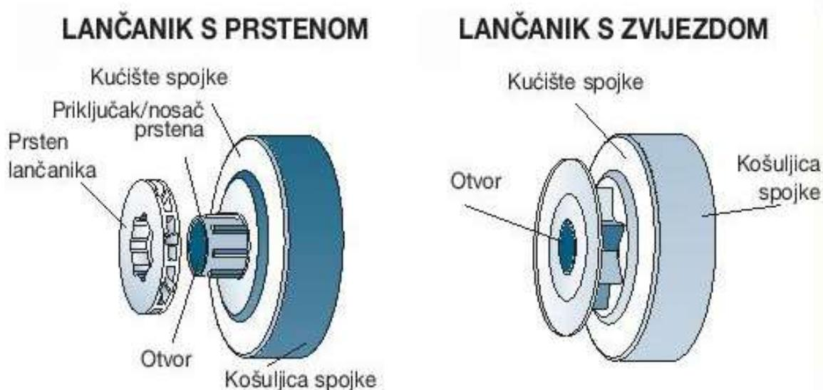
Slika 12. Vrste pogonskih lančanika [9]
