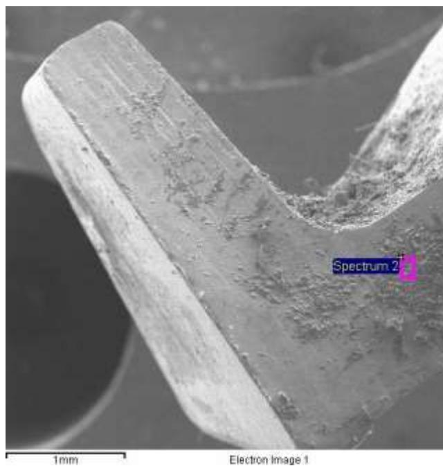
Slika 42. EDS analiza naljepljina na bočnoj strani uzorka 2
