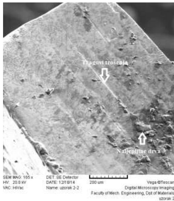
Slika 41. Tragovi trošenja na reznoj površini uzorka 2
