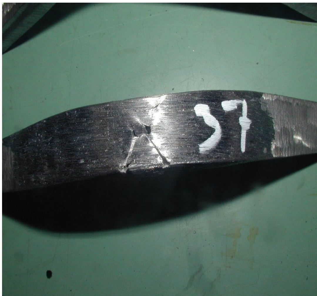
Slika 18. Epruveta koja nije zadovoljila testiranje savijanjem [19]
