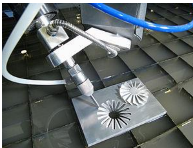
Slika 5. Rezanje metala vodenim mlazom
