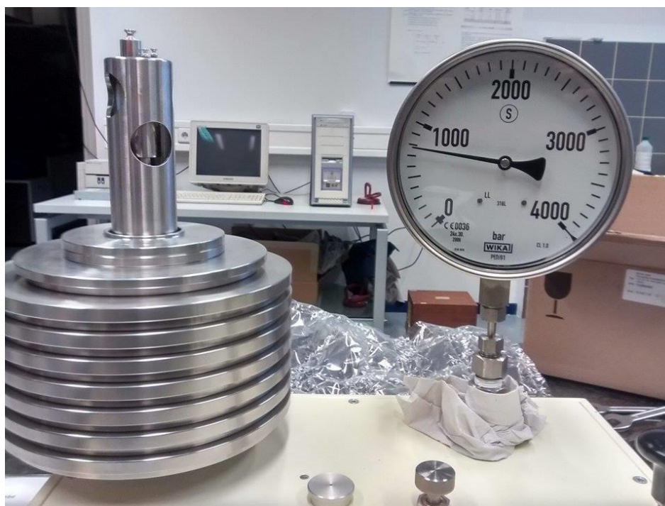
Slika 13. Mjerna linija referentnog laboratorija
