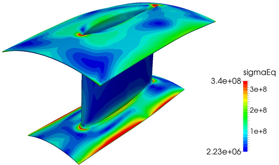
Slika 35 Ekvivalentno naprezanje 2. slucaj
