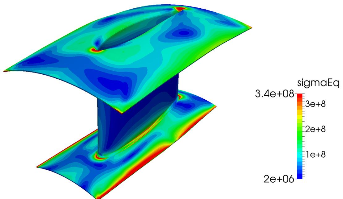
Slika 27 Ekvivalentno naprezanje 1. slucaj
