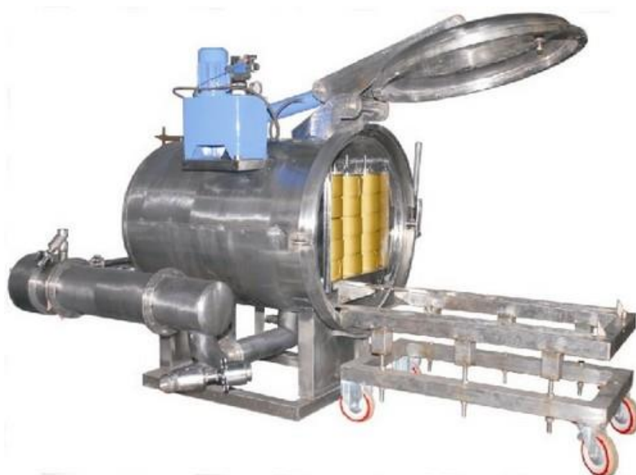
Slika 2. Aparat (kupa) za bojenje konca [3]
