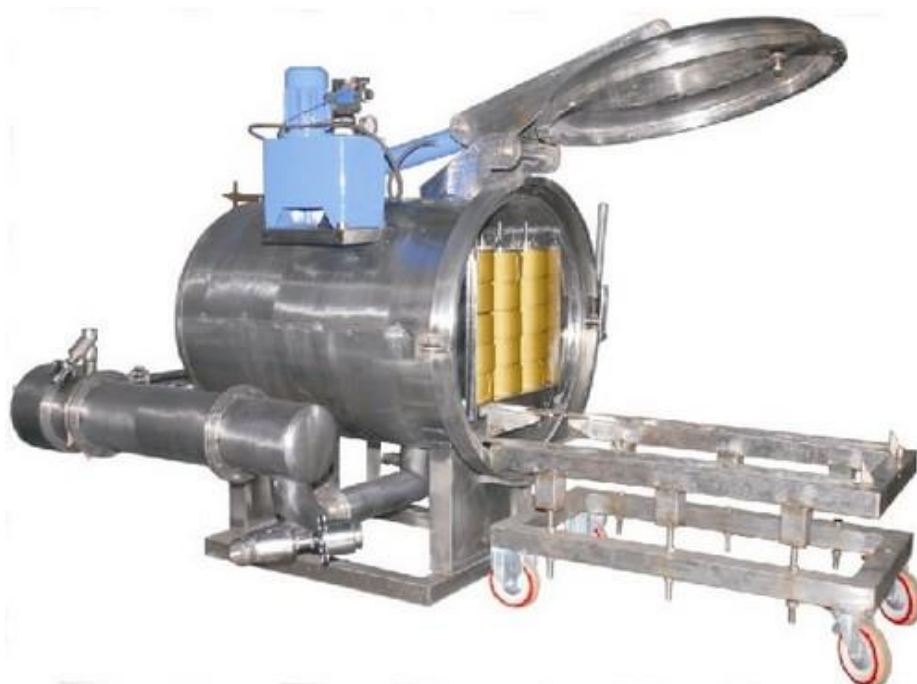
Slika 2. Aparat (kupa) za bojenje konca [3]
