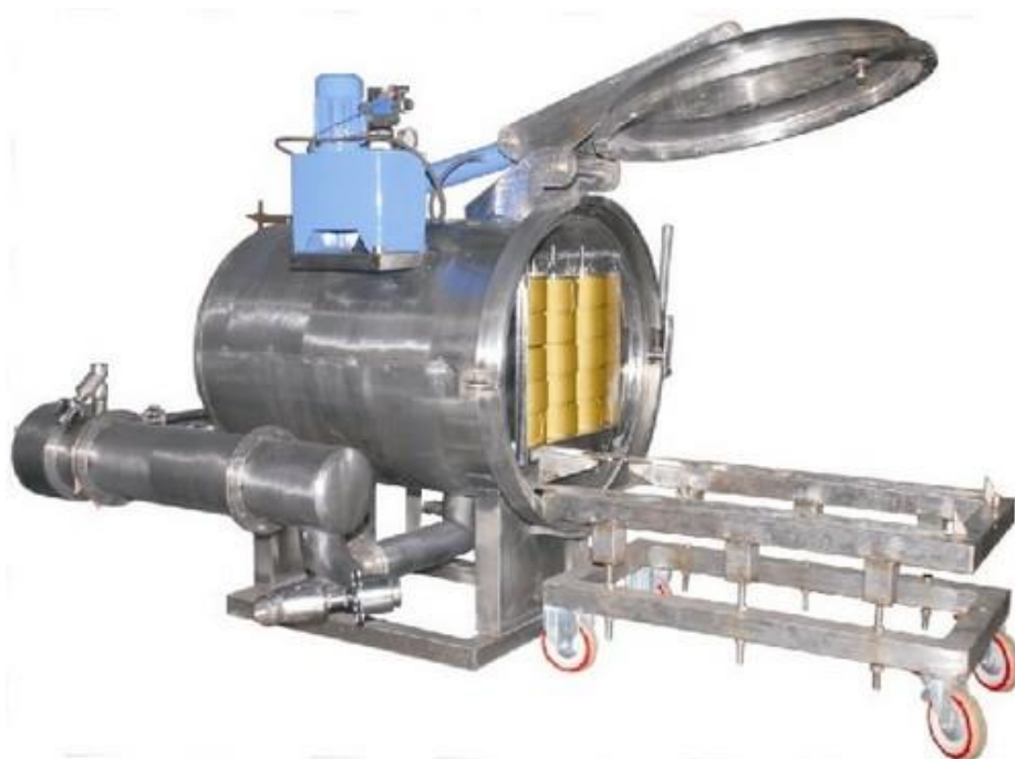
Slika 2. Aparat (kupa) za bojenje konca [3]
