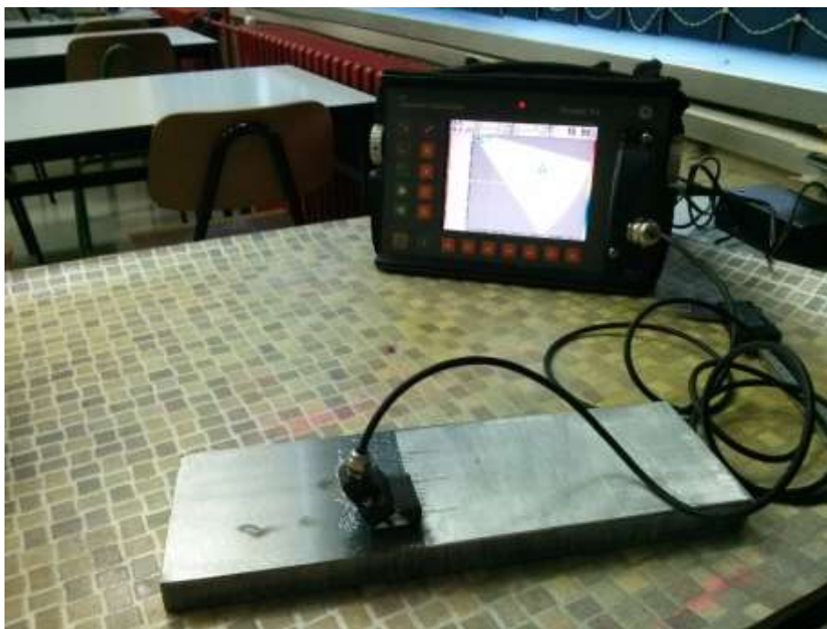
Slika 6.14 Postavljeni eksperiment – uređaj, sonda i graničnik za pozicioniranje sonde
