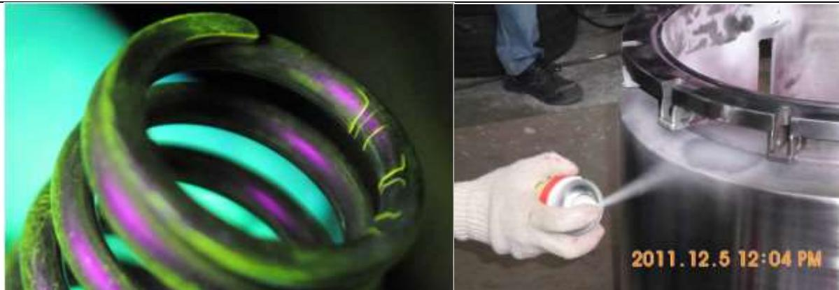
**Slika 2.3 Ispitivanje penetrantima: UV penetrant (lijevo) (izvor: technologyplusinc.com), nanošenje razvijača (desno)**
