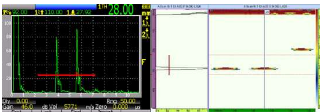
Slika 5.9 A-prikaz zvučnog snopa koji se reflektira od dvije indikacije na različitim dubinama i B-prikaz uzorka s tri indikacije dobiven pregledom sondom koherentnog ultrazvučnog polja (desno)(izvor: http://olympus-ims.com )
