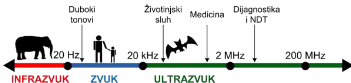
Slika 3.1 Frekvenzijski spektar zvučnih valova
