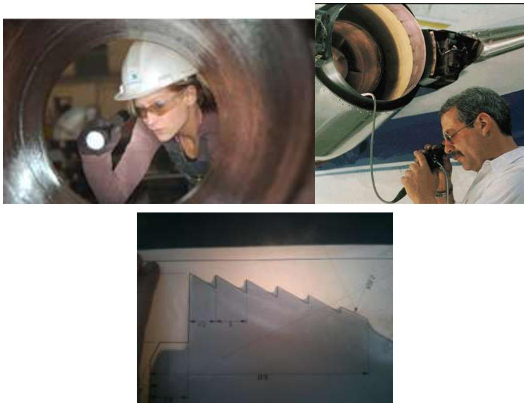
**Slika 2.1 Primjeri metoda vizualne kontrole: vizualno (izvor: spectrum.ndt.com), boroskopom (izvor: iprt.iastate.edu) i pomoću profil projektoru**
