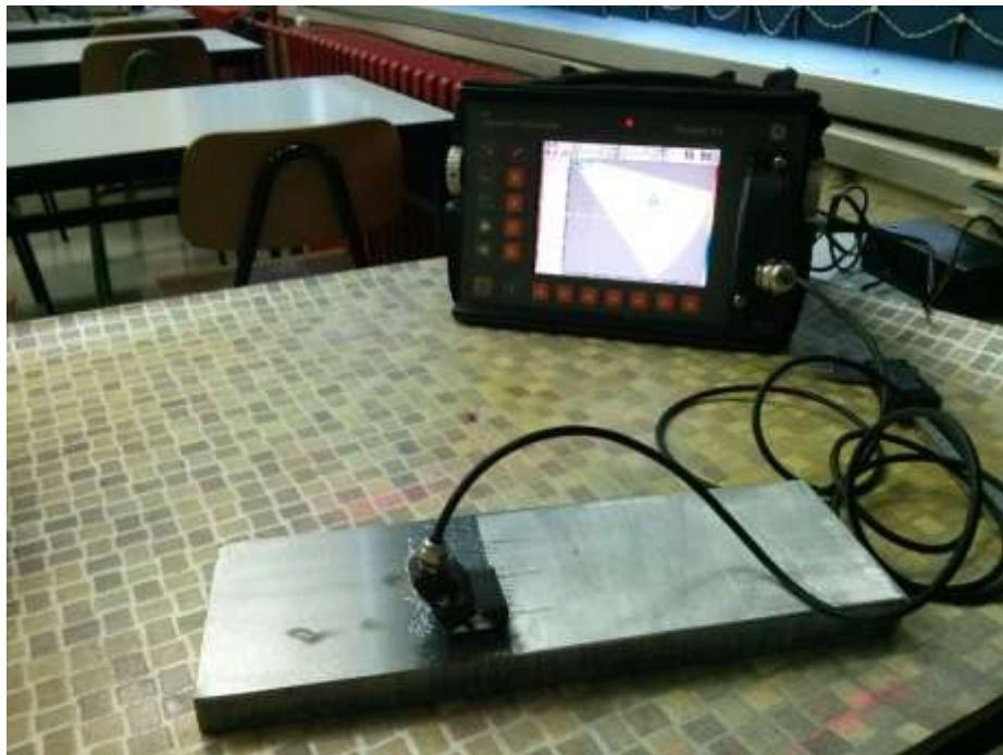
Slika 6.14 Postavljeni eksperiment – uređaj, sonda i graničnik za pozicioniranje sonde
