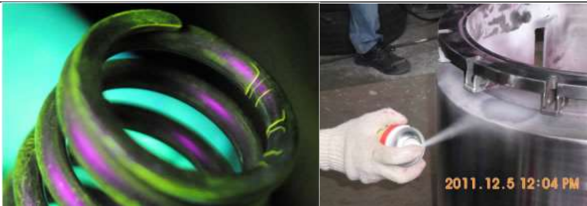
Slika 2.3 Ispitivanje penetrantima: UV penetrant (lijevo) (izvor: technologyplusinc.com), nanošenje razvijaa (desno)
