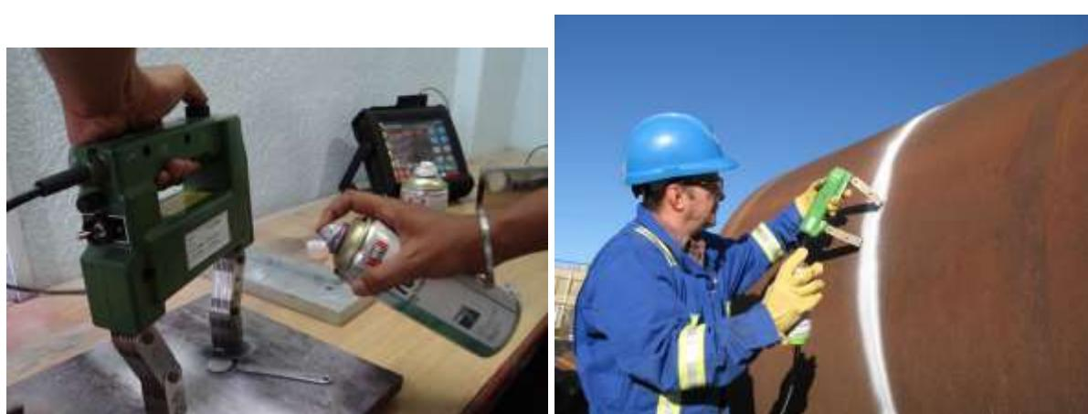
Slika 2.5 Ispitivanje magnetskim česticama
