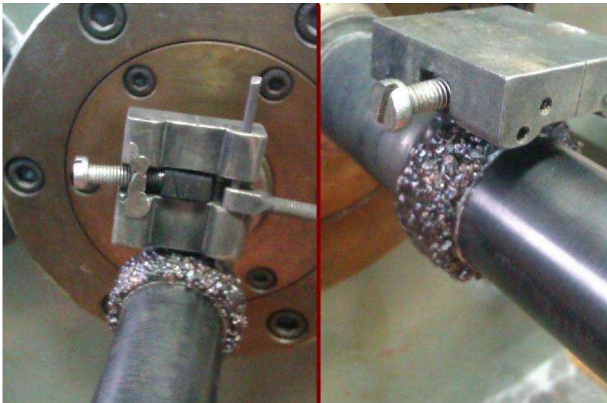
Slika 34. Ispitivanje faktora trenja
