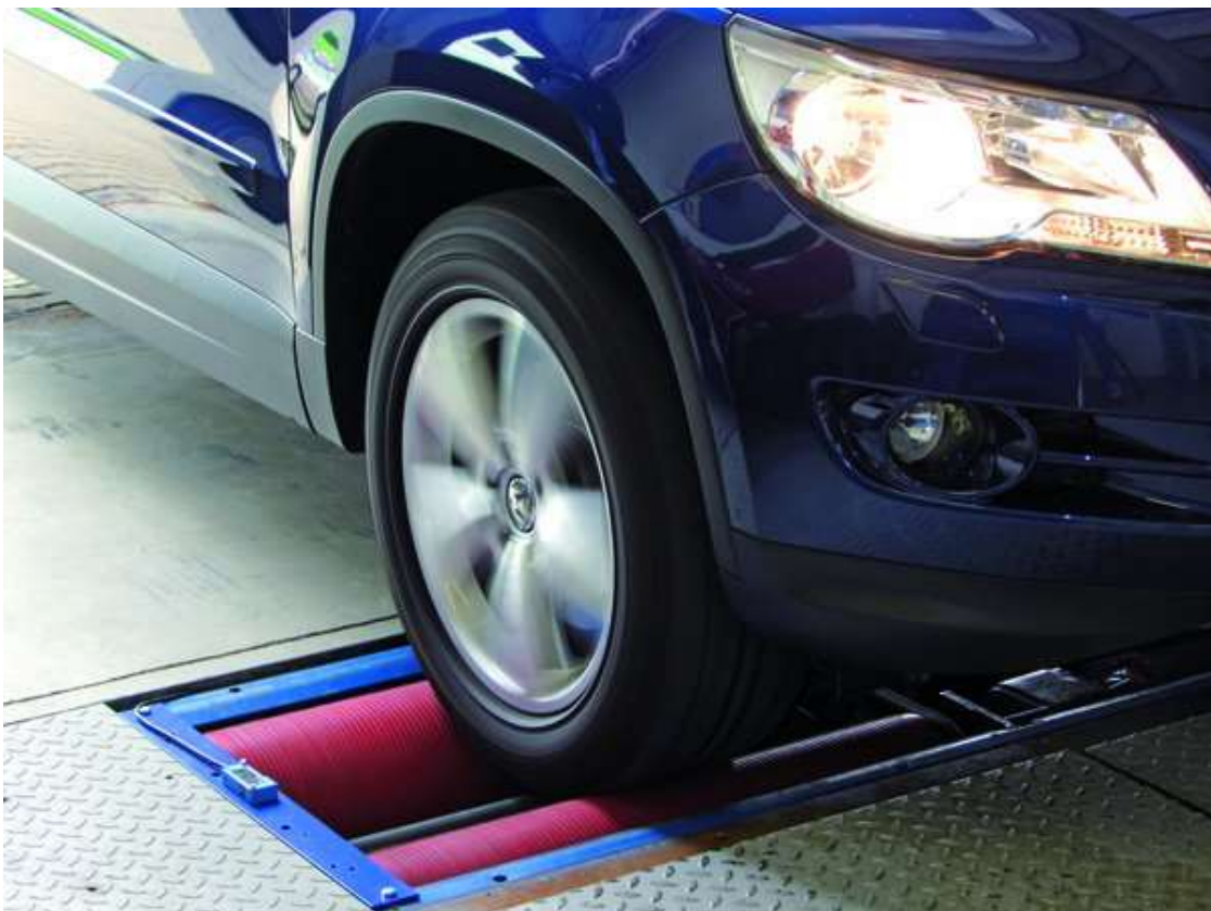
Slika 3. Vozilo na valjcima za ispitivanje sile kočenja [3]
