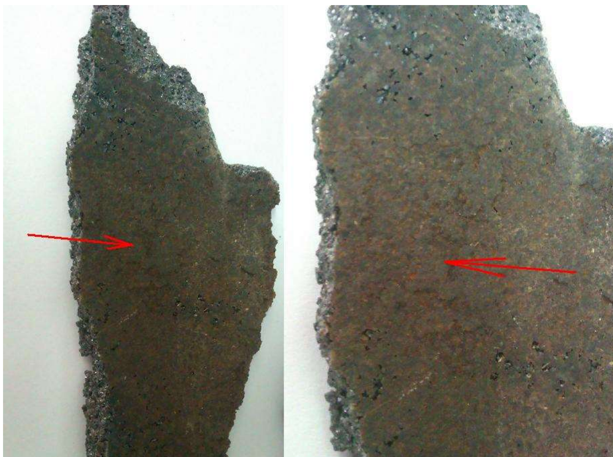
Slika 20. Kontaktna površina prevlake i valjka
