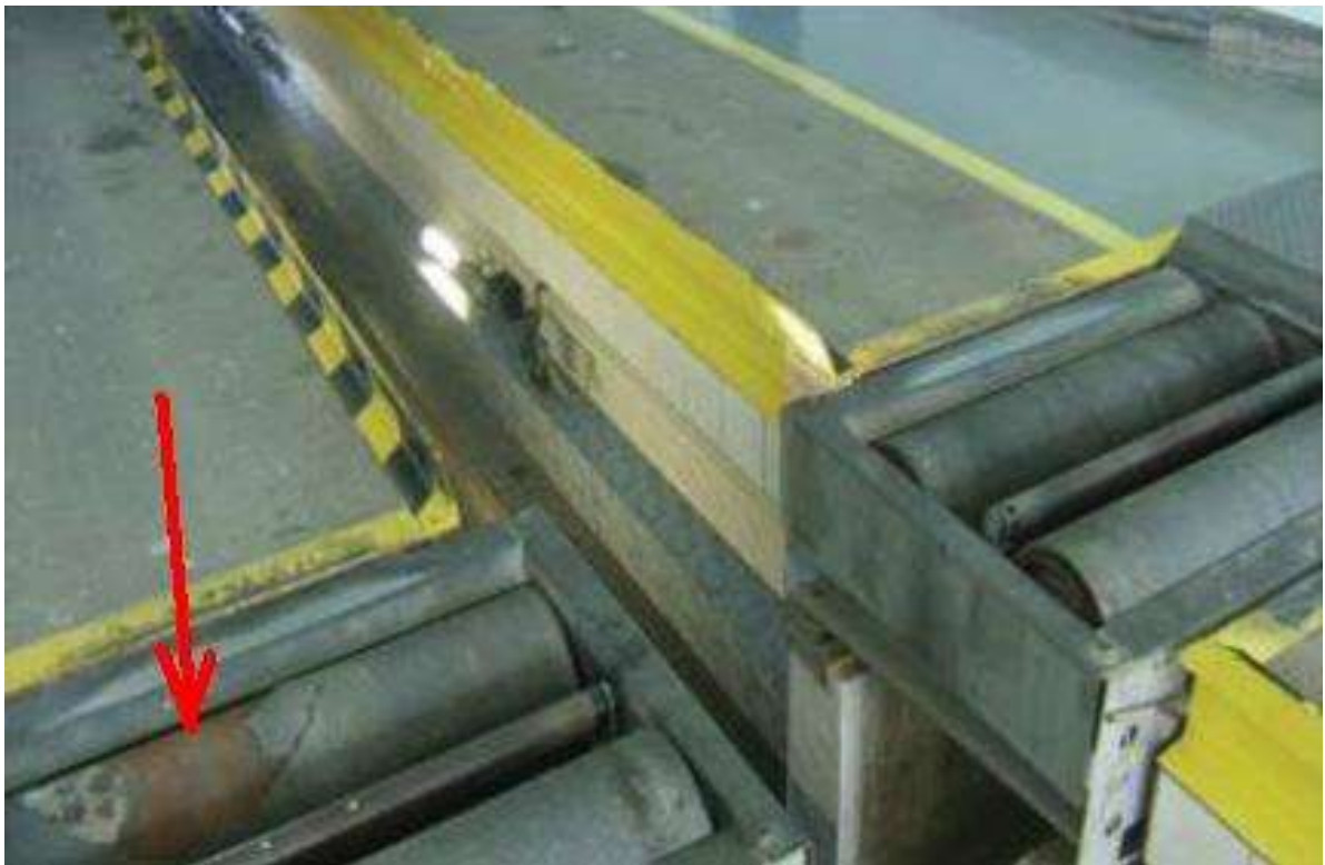
Slika 11. Valjak s kojeg je otpao sloj kompozitne prevlake
