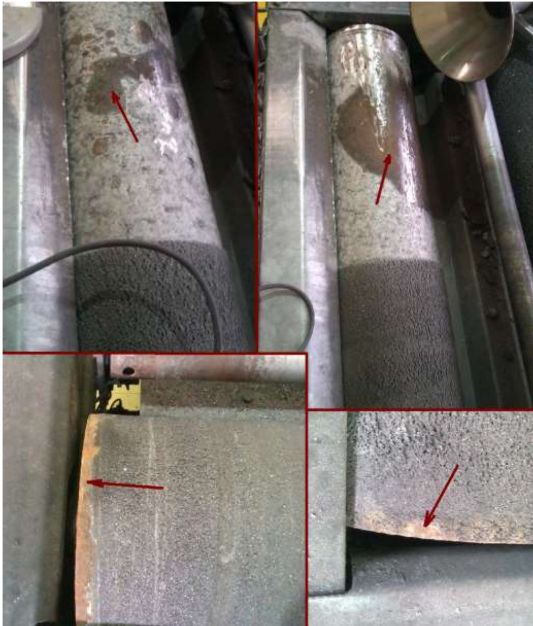
Slika 36. Produkti korozije na valjcima
