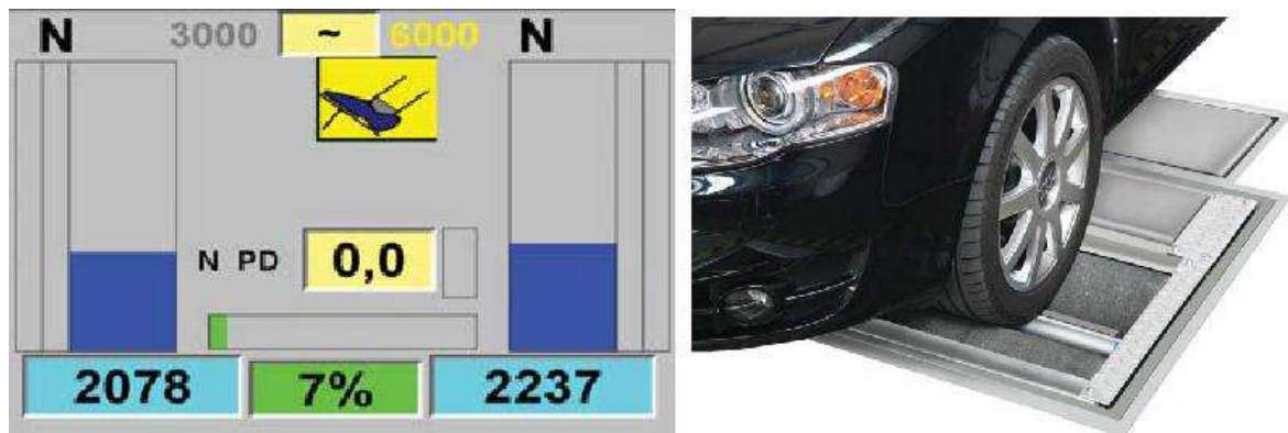
Slika 6. Izgled valjaka i pokaznog uređaja sile kočenja- Cartec [8]
