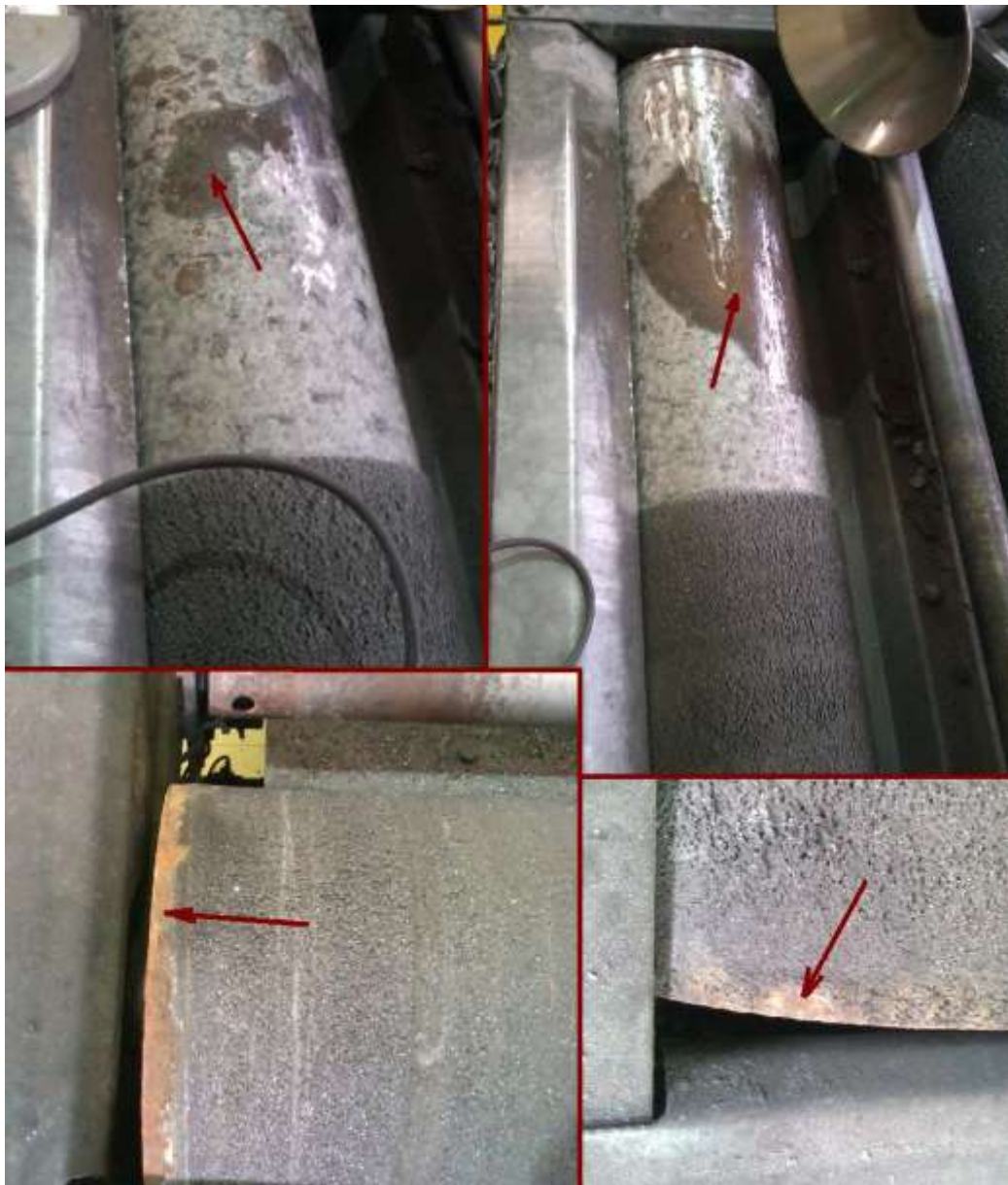
Slika 36. Produkti korozije na valjcima
