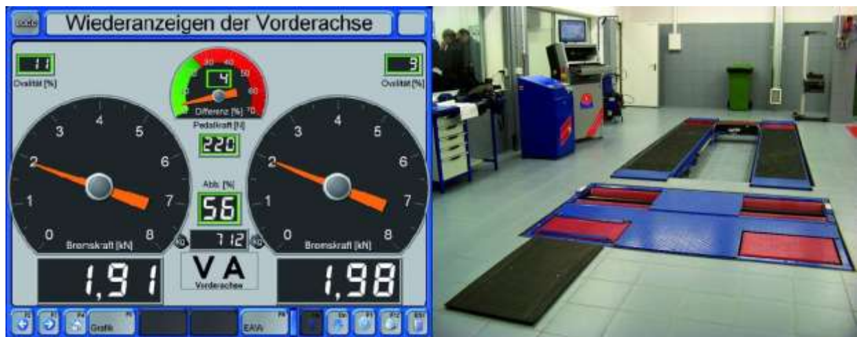
Slika 7. Izgled valjaka i pokaznog uređaja sile kočenja- Maha [9]
