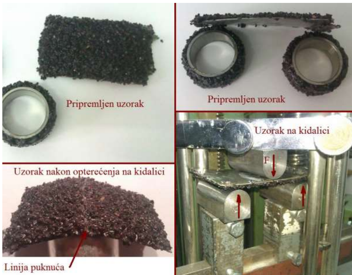
Slika 35. Ispitivanje uzorka na kidalici
