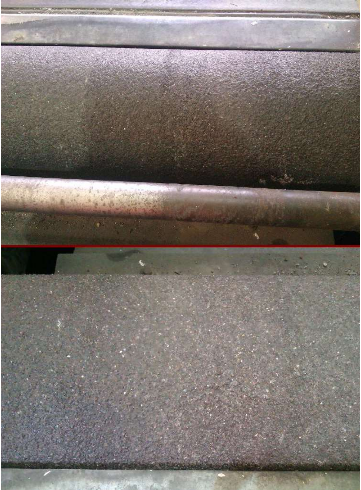
Slika 32. Površina obnovljenih valjaka
