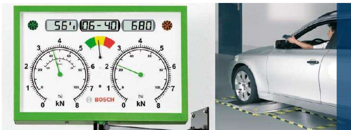
Slika 8. Izgled valjaka i pokaznog uređaja sile kočenja- Bosch [10]
