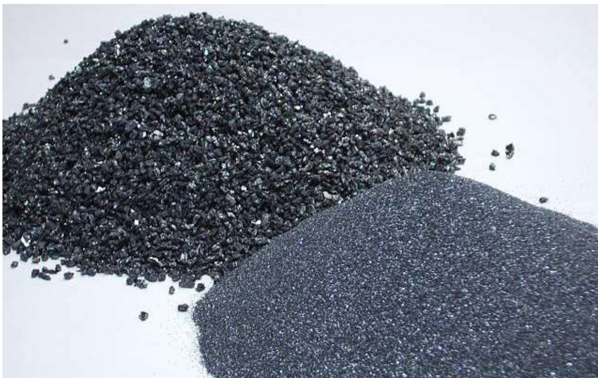
Slika 25. Granulat silicijevog karbida- SiC [25]
