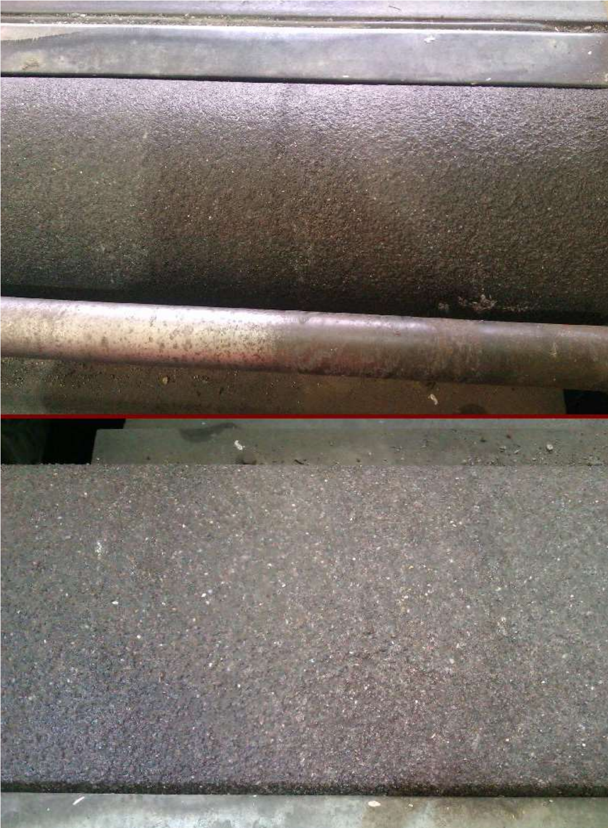
Slika 32. Površina obnovljenih valjaka
