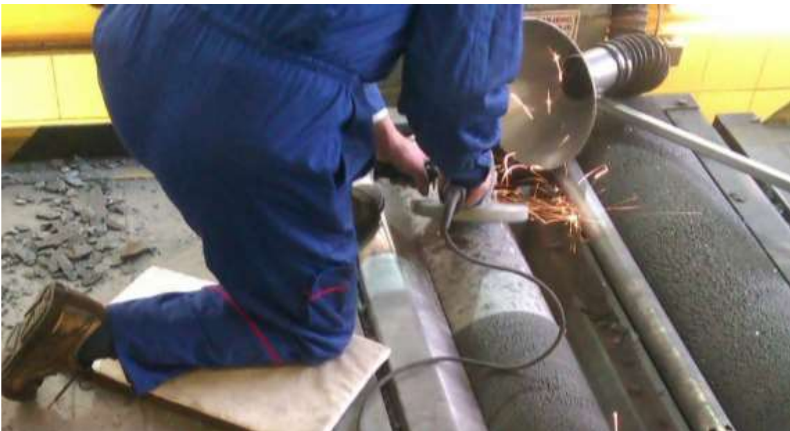
Slika 28. Brušenje valjaka radi boljeg prijanjanja nove kompozitne prevlake
