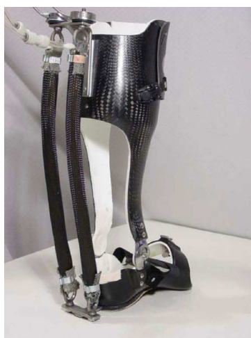
Slika 2.13. Ortoza za stopalo pokretana dvama pneumatskim mišićima [12]
