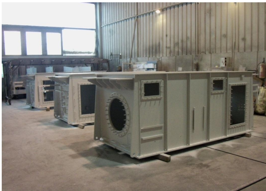
Slika 2. Dvodijelni transformatorski kotao [3]
