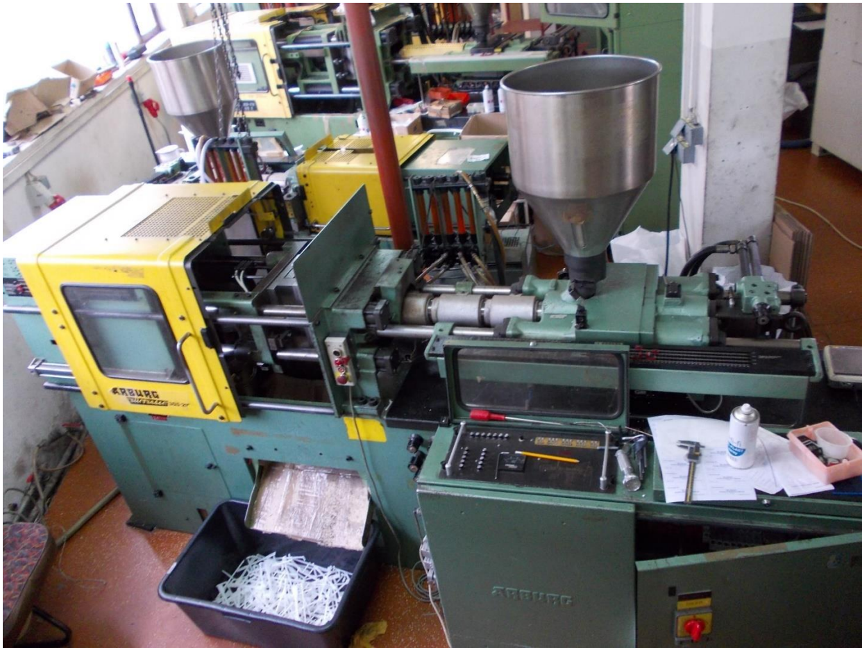
Slika 6.4. Ubrizgavalica proizvođača Arburg , model Allrounder 305-210-700
