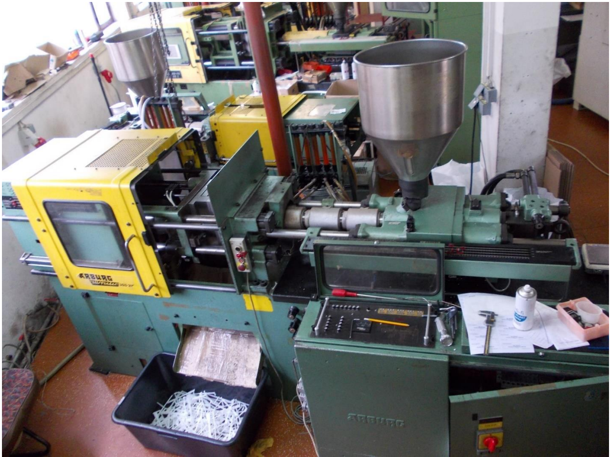
Slika 6.4. Ubrizgavalica proizvođača Arburg , model Allrounder 305-210-700
