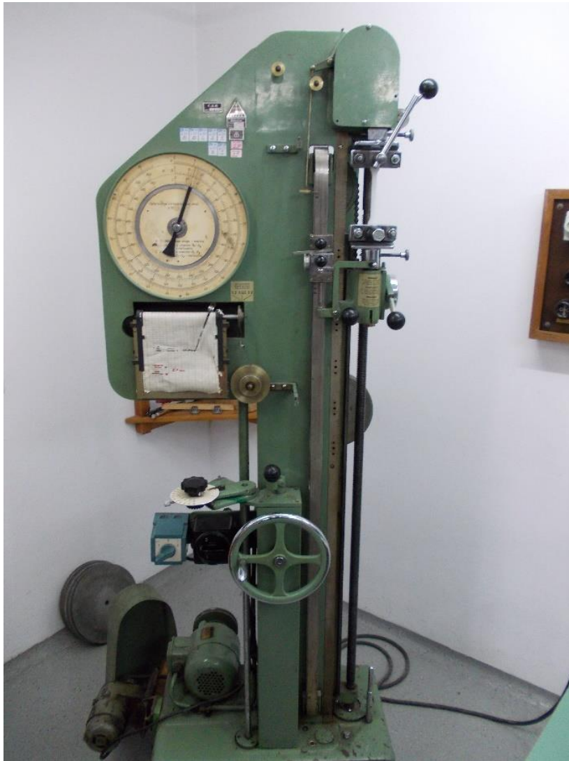
Slika 6.9. Univerzalna kidalica proizvođača WPM
