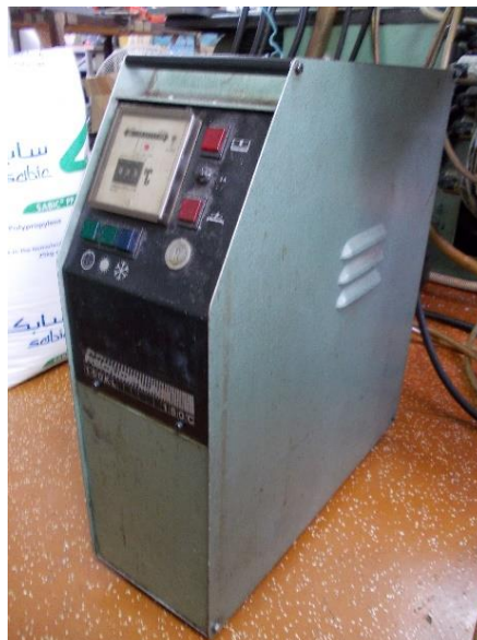
Slika 6.3. Temperiralo proizvođača Regloplas
