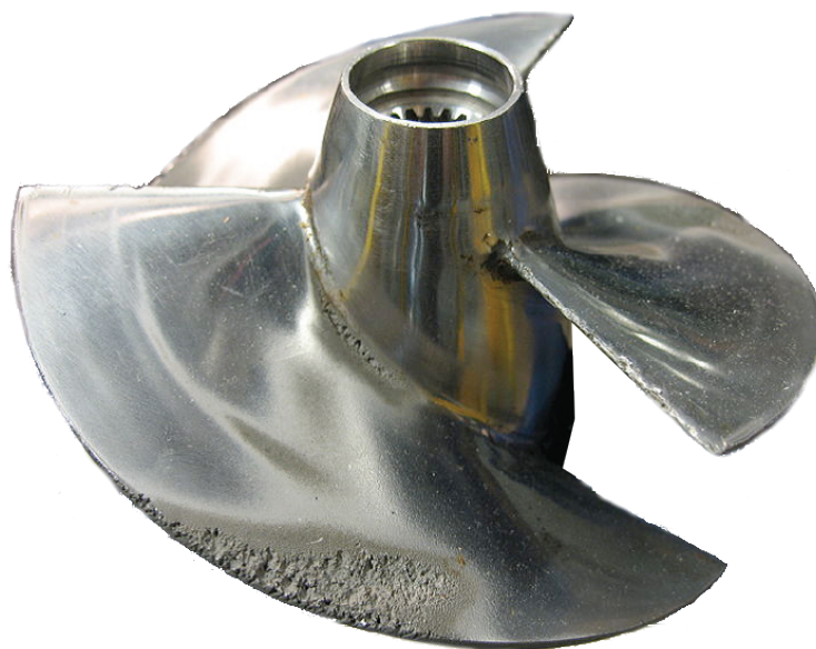
Slika 1.19: Posljedica kavitacijske erozije lopatici propelera
