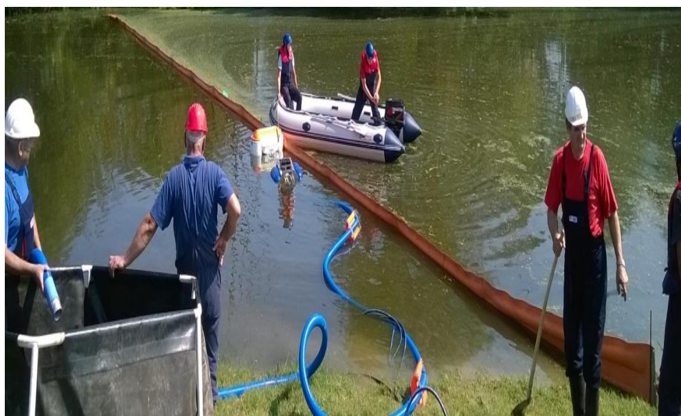
Slika 40. Simulacija prikupljanja nafte skimerima, [11]
