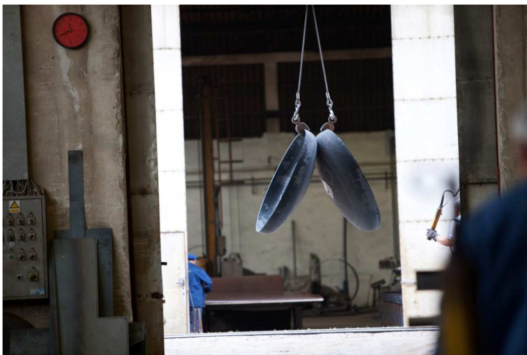
Slika 3. Podnice izrađene hladnim oblikovanjem spremne za normalizaciju [1]
