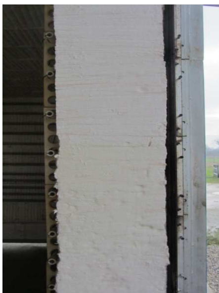
Slika 13. Izolacija peći pomoću keramičkih vlakana
