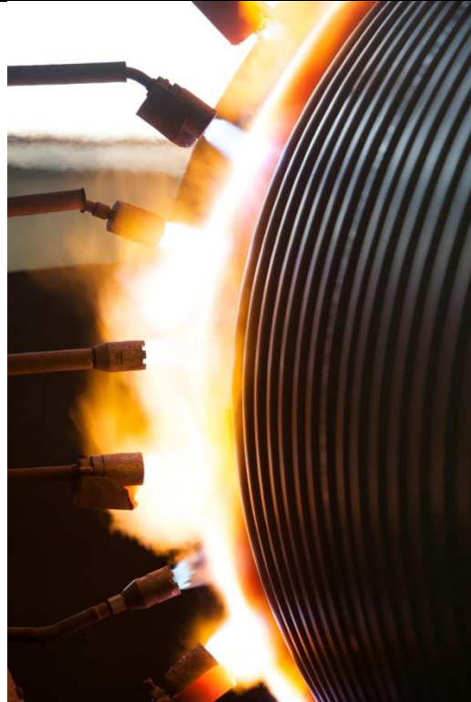
Slika 5. Način zagrijavanja plamenice [1]
