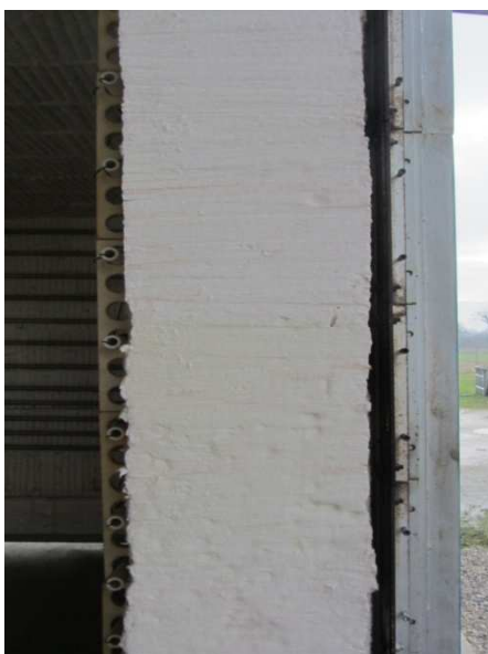
Slika 13. Izolacija peći pomoću keramičkih vlakana
