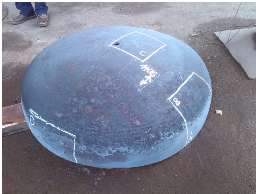
Slika 24. Podnica s označenim uzorcima za ispitivanje
