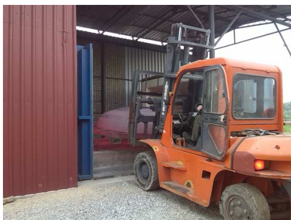
Slika 22. Vađenje proizvoda za hlađenje na mirnom zraku
