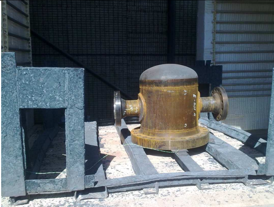
Slika 9. Distributor sa spojenim termoelementom prije žarenja [1]
