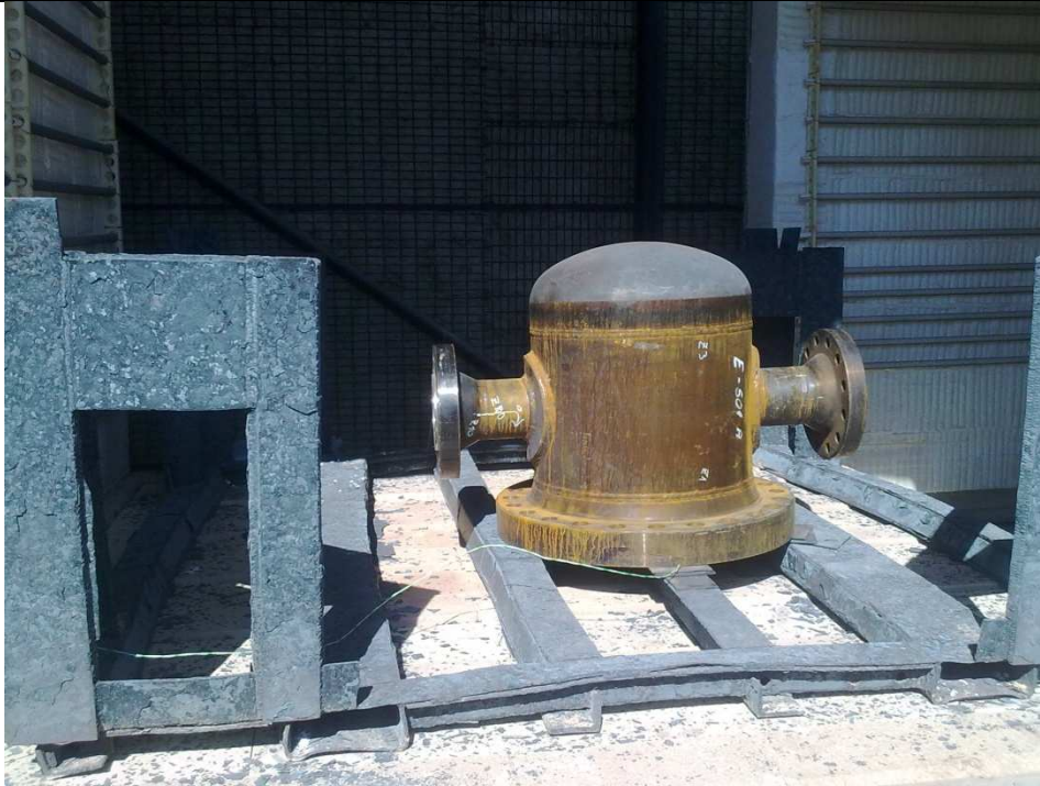
Slika 9. Distributor sa spojenim termoelementom prije žarenja [1]
