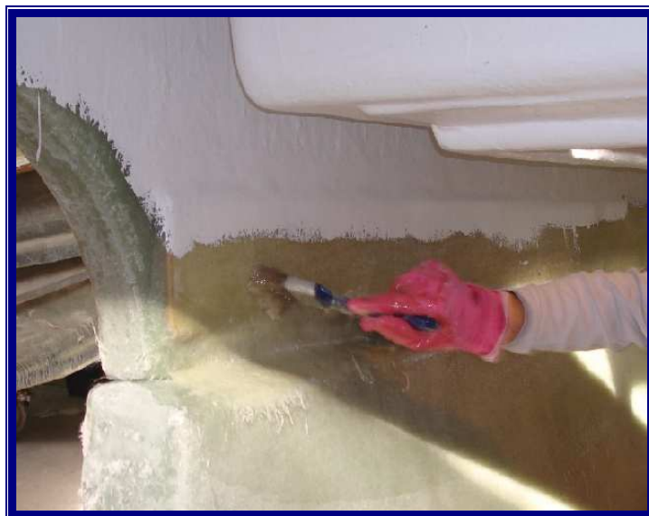
Slika 3.8 Laminiranje unutarnjeg spoja palube i dna
