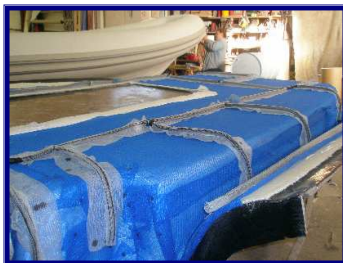
Slika 4.20 Najviši krug cjevovoda smole
