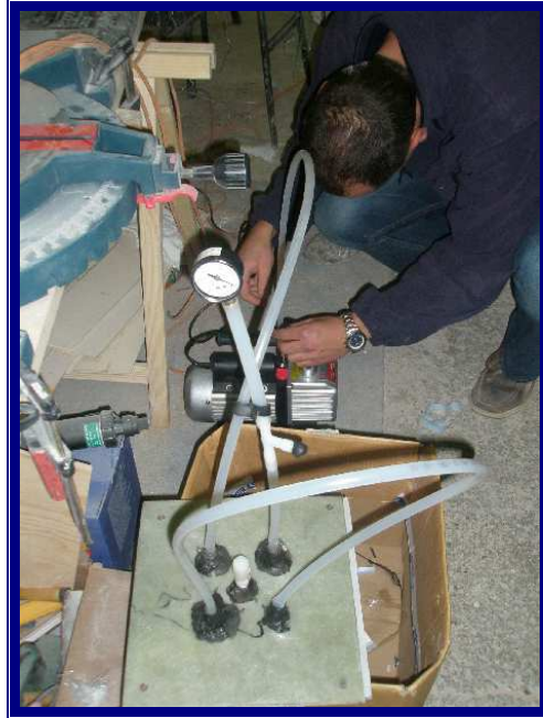
Slika 4.24 Spajanje vakuumskih cjevovoda na pumpu i separator
