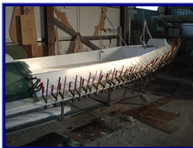
Slika 3.7 Spajanje odljevaka palube i dna
