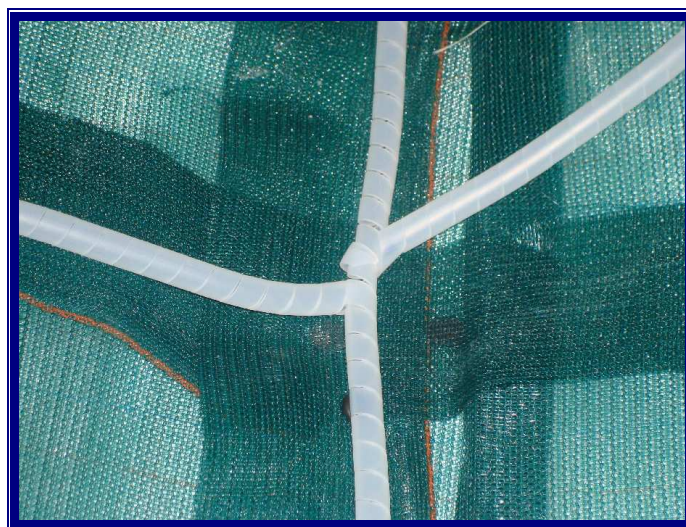
Slika 4.14 Postavljanje cjevovoda smole
