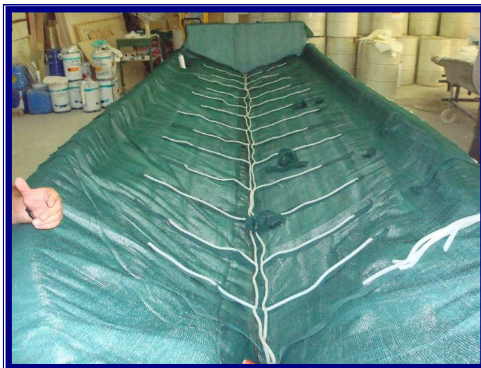
Slika 4.14 Postavljanje cjevovoda smole
