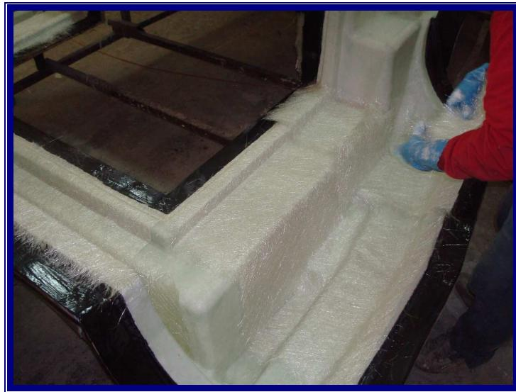
Slika 4.17 Postavljanje prvog sloja laminata na kalup palube
