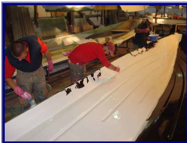
Slika 3.1 Nanošenje zaštitno - dekorativnog sloja
