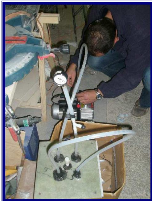
Slika 4.24 Spajanje vakuumskih cjevovoda na pumpu i separator
