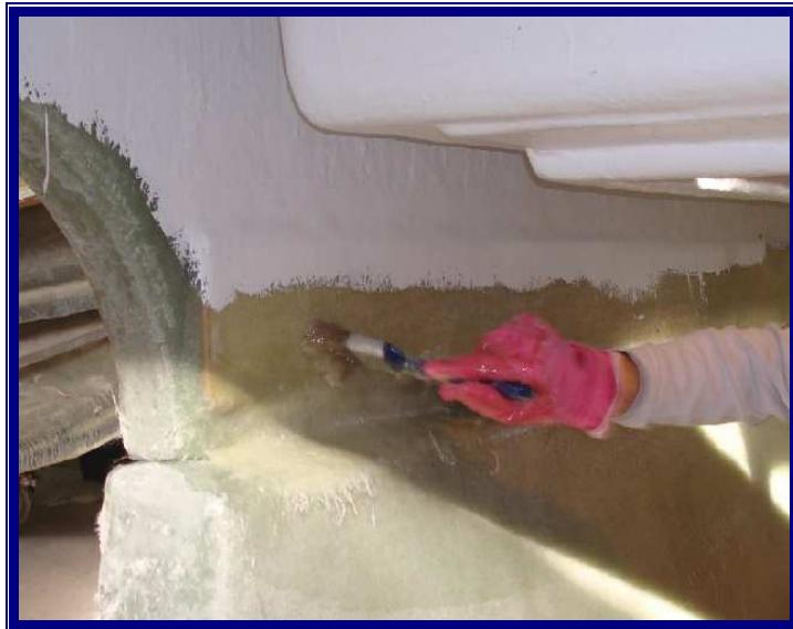
Slika 3.8 Laminiranje unutarnjeg spoja palube i dna
