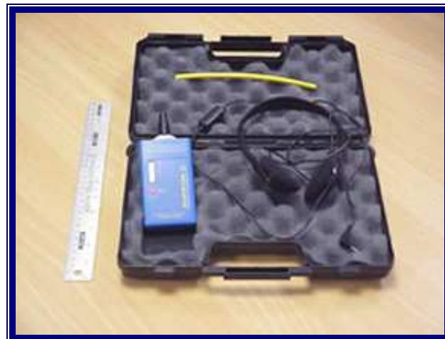
**Slika 4.25 Detektor propusnosti vakuuma**
