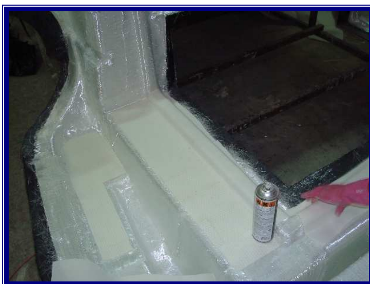
Slika 4.18 Polaganje SoricXF3 ojačanja na mjesta većih opterećenja
